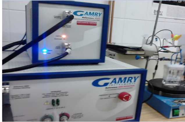
Şekil 3.2. Gamry Reference 3000 model Potentiostat/Galvanostat ZRA cihazı.
