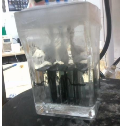
Şekil 3.4. Şarj-deşarj testleri için oluşturulmuş elektrokimyasal hücre.
