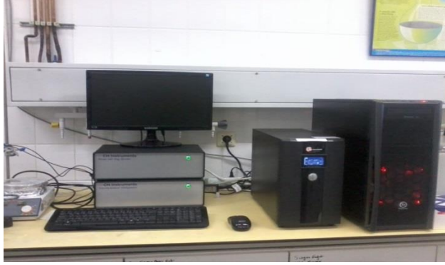
Şekil 3.1. CHI 660 D model potantiyostat/galvanostat cihazı.
