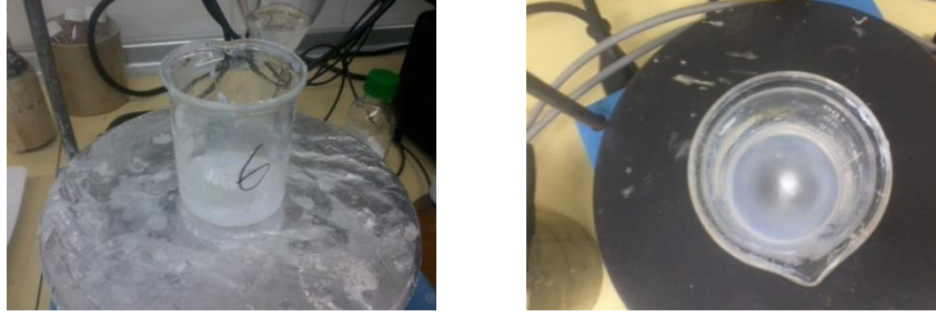
Şekil 3.5. Jel elektrolit sistemlerinin hazırlanışı.
