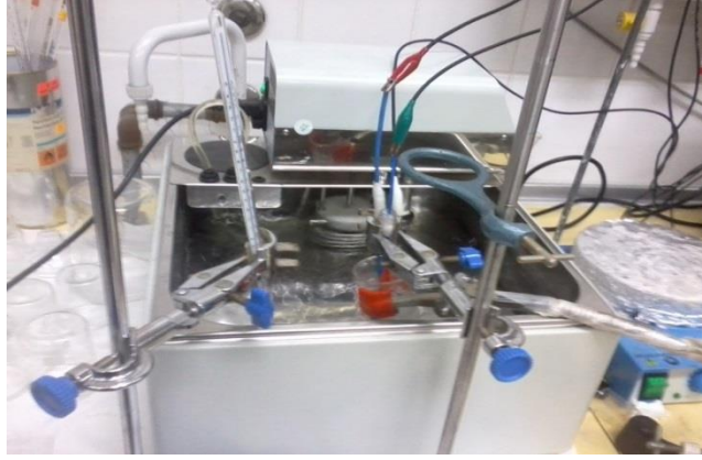
Şekil 3.3. CV ve EIS ölçümlerinin yapıldığı sıcaklık kontrollü deney düzeneği.
