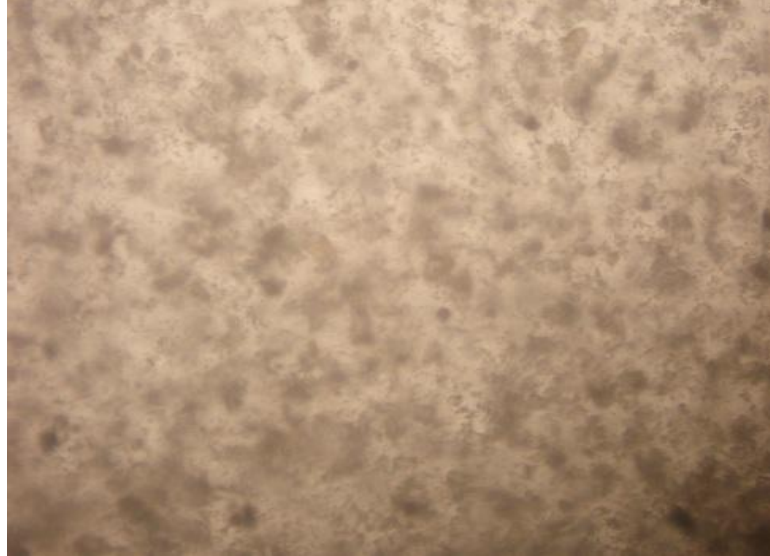
Şekil 6.2. Kütlege % 6 fumed silika ile 1:1 oranında hazırlanan \text{SiO}_2\text{:Al}_2\text{O}_3 elektrolit sistemine ait a) jelleşme öncesi ve b) jelleşme sonrası 10x büyütme görüntüleri
