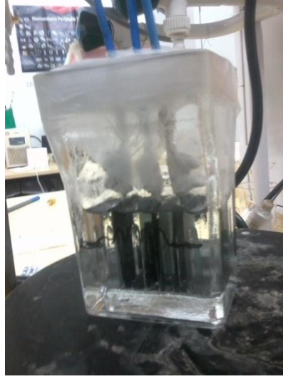
Şekil 3.5. Şarj-deşarj testleri için oluşturulmuş elektrokimyasal hücre
