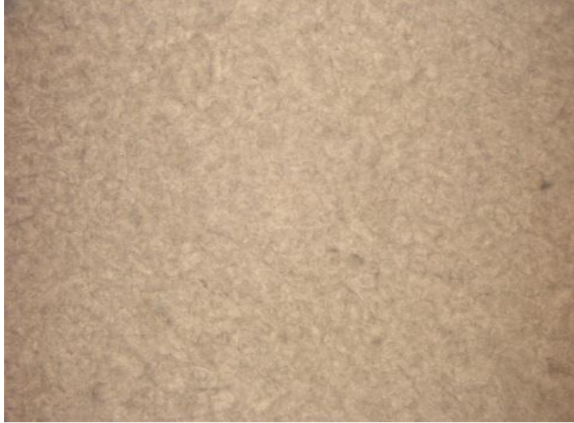
Şekil 6.9. Kütlece % 6 fumed silika karışımına 0,25 g \text{MgSO}_4 eklenerek hazırlanan elektrolit sistemine ait a) jelleşme öncesi ve b) jelleşme sonrası 10x büyütmeli görüntüler
