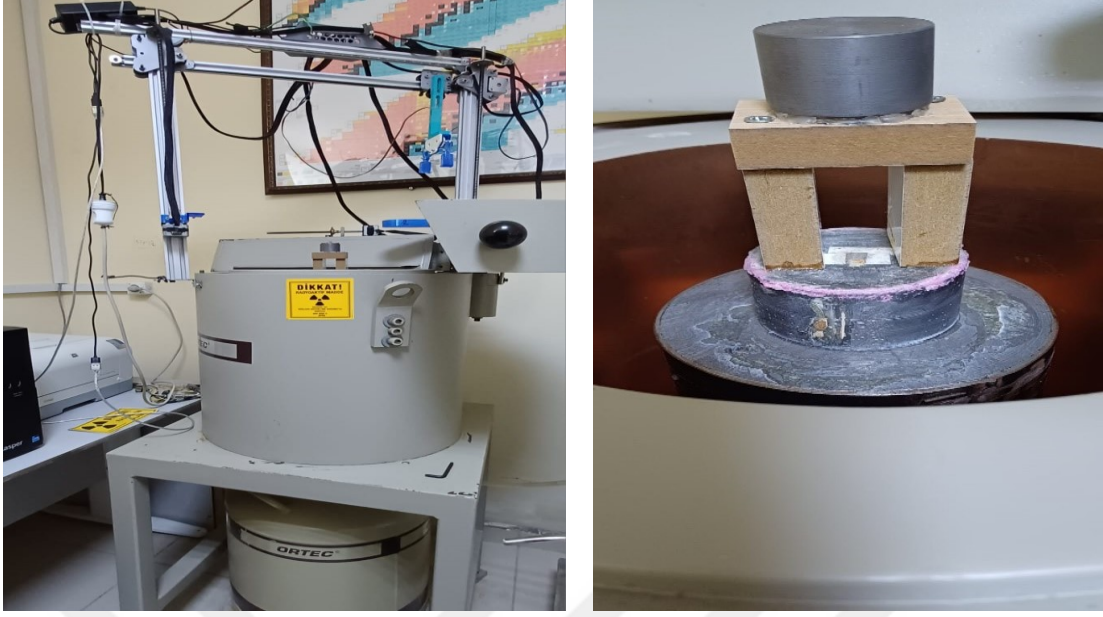
Şekil 15. Germanyum dedektör (HPGe) sisteminin görünüşü
