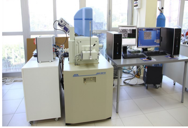
Şekil 17. SEM/EDX JOEL 6610 taramalı elektron mikroskobu (RTE Üniversitesi)
