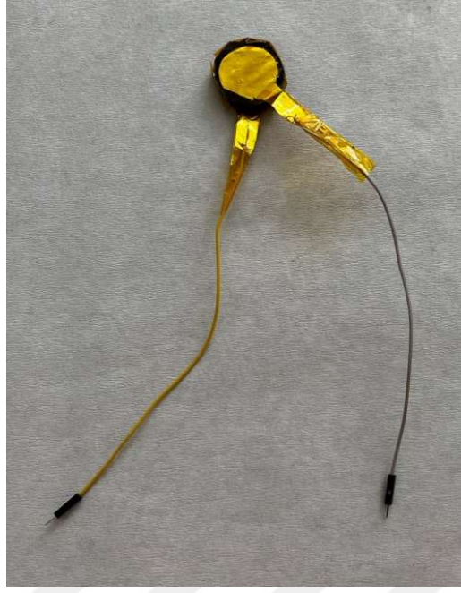
Şekil 3.8. Açık devre voltaj ölçümüne hazırlanmış numune
