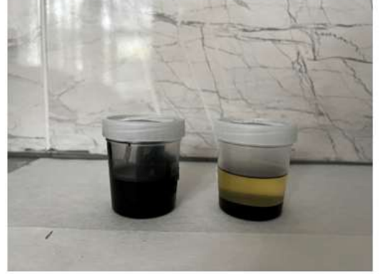
Şekil 4.7. Çözücü ile genişleme metodu numuneleri a) Tüm numuneler b) VUP ve UVUP
