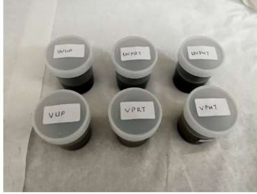
Şekil 4.7. Çözücü ile genişleme metodu numuneleri a) Tüm numuneler b) VUP ve UVUP
