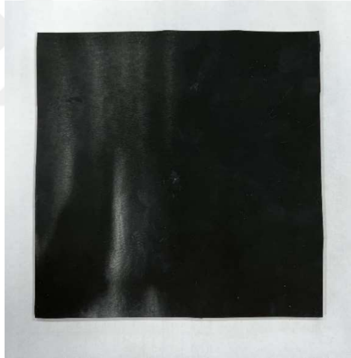
Şekil 3.3. Basınç kalıplama ile vulkanize edilmiş FKM plaka
