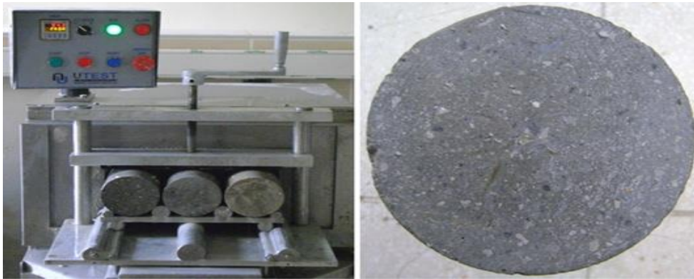
Şekil 3.9. Numune başlıklama cihazı ve yüzeyi düzeltilmiş örnek
