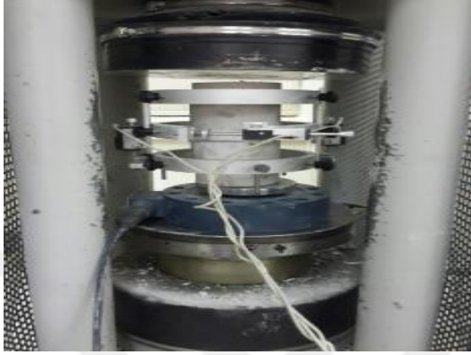
Őekil 3.12. Deformasyon deđerlerini belirlemede kullanılan kompressometre
