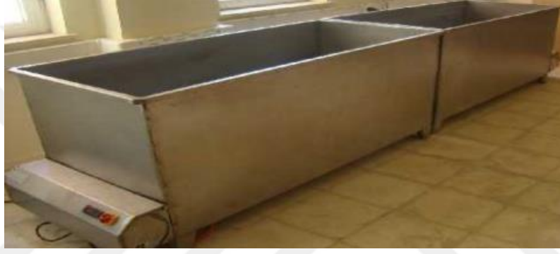
Şekil 3.8. Isı kontrollü kür havuzları
