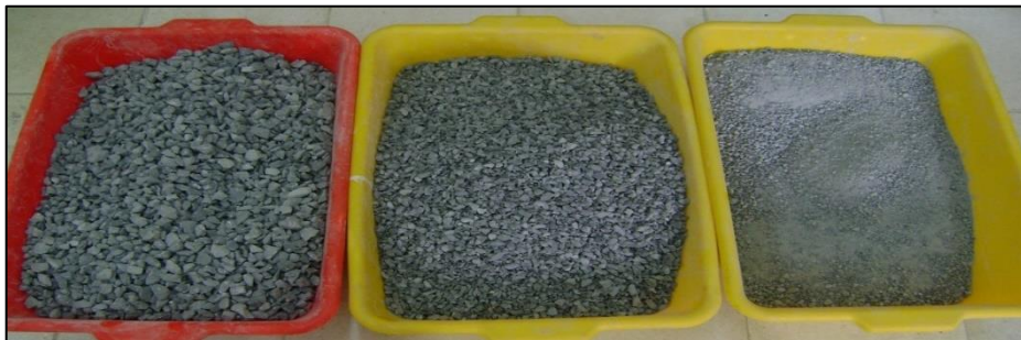
Şekil 3.3. Çeneli kırıcıda kırılmış sınıflarına ayrılmış kurşun madeni atığı kayaçları
