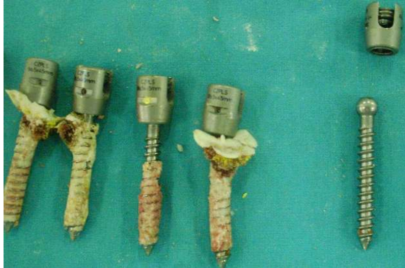
Şekil 3.8. PMMA grubu vidaları. Pedikül yolu PMMA ile güçlendirilmiş vertebraların test sonundaki vida görüntüleri. PMMA'nın tüm vida yivlerinde bulunduğu görülmektedir. Sökülme testleri sonunda vida başının koptuğu pedikül vidası en sağda bulunmaktadır.
