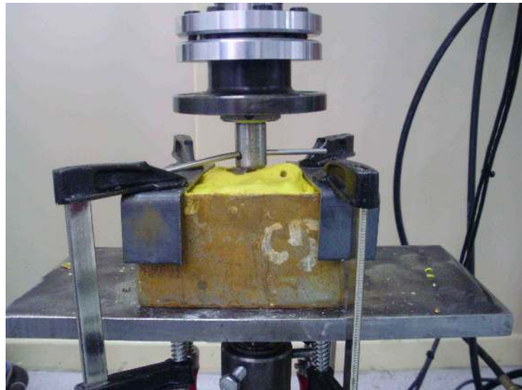
Şekil 3.4. Sökölme testi düzeneği. Pedikül vidaları konulmuş, gömme kabında sabitlenmiş vertebralar alt tablaya dört adet kelepçe yardımıyla sabitlendi. Proksimal taraf ise pedikül vida başına uygun tutma çenesine 5.0mm rod yardımı ile sabitlendi. Tüm gömme kaplarının üzerine vertebraların kodlanmış isimleri yazıldı.
