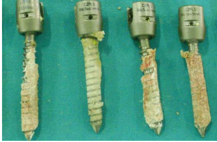
Şekil 3.7. Kalsiyum sülfat grubu vidaları. Pedikül yolu kalsiyum sülfat ile güçlendirilmiş vertebraların test sonundaki vida görüntüleri. Kalsiyum sülfat greftin vidanın tüm yivleri boyunca bulunduğu gözlemlenmektedir.
