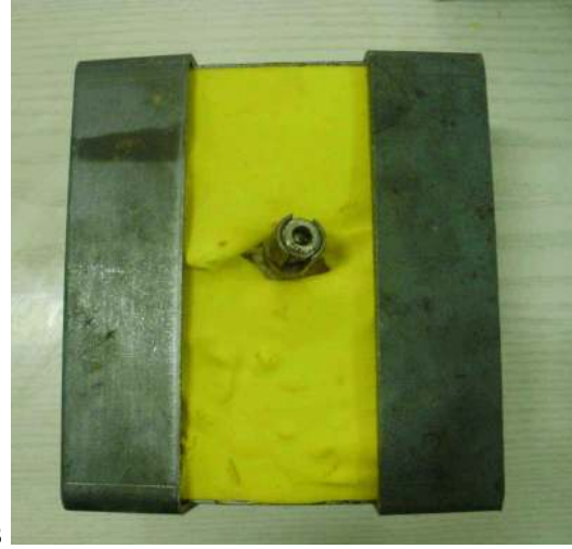
Şekil 3.3. Vertebraanın gömme işlemi.A) Sabitleyici çimentonun uygulanışı. B) Sabitleyici çimentonun donduktan sonraki görüntüsü, uygulanan sabitleyici çimentonun pedikül vidasının kemiğe giriş bölgesinde vidaya temas etmemesi sağlandı, sökölme testlerinde örnek çimentolarının alt sabitlemeyi yapacak kelepçelerce kırılmasını engellemek için üstteki u şeklinde destekler her bir örnek için ayrıca hazırlanmıştır.
