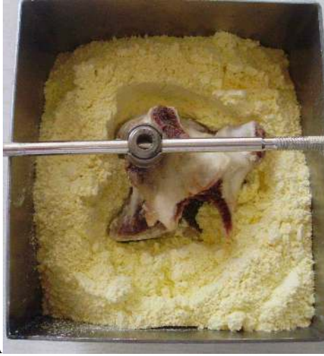
Şekil 3.3. Vertebraanın gömme işlemi.A) Sabitleyici çimentonun uygulanışı. B) Sabitleyici çimentonun donduktan sonraki görüntüsü, uygulanan sabitleyici çimentonun pedikül vidasının kemiğe giriş bölgesinde vidaya temas etmemesi sağlandı, sökölme testlerinde örnek çimentolarının alt sabitlemeyi yapacak kelepçelerce kırılmasını engellemek için üstteki u şeklinde destekler her bir örnek için ayrıca hazırlanmıştır.
