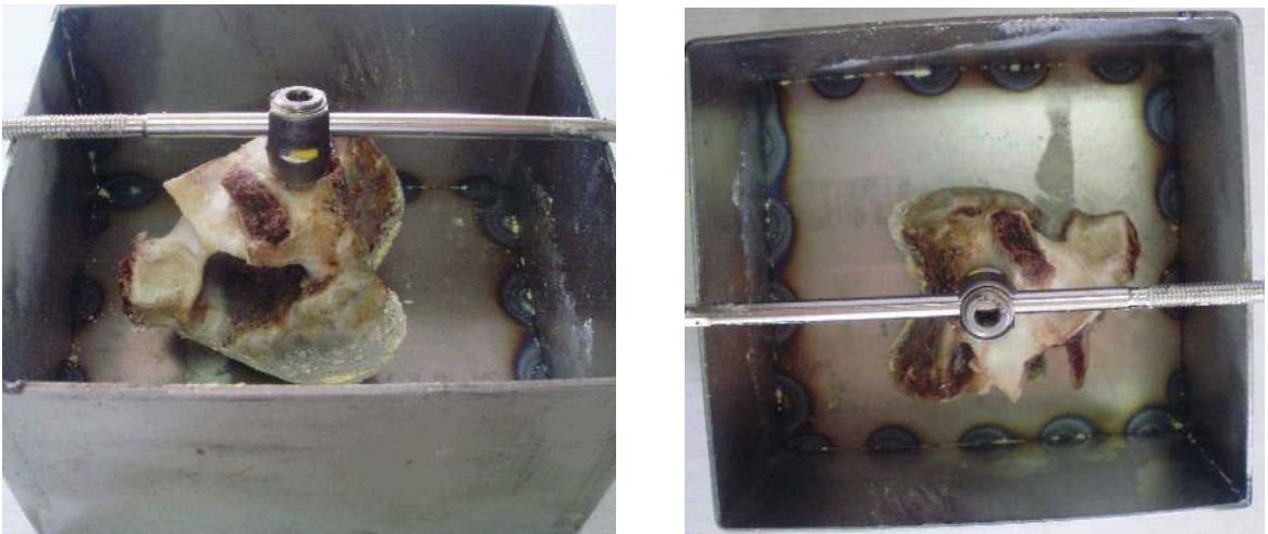
Şekil 3.2. Pedikül vidası uygulanmış vertebranın gömme kabındaki görüntüsü. Tüm vertebralarda sökölme kuvvetinin aksiyel yönde uygulanabilmesi için 5.0mm şanz kullanılarak pedikül vidası sabitlenmiştir. Gömme işlemlerinde vertebraların gömme kablarına tamamen yerleştirilebilmesi için spinöz ve transvers proçesler kesilmiştir.
