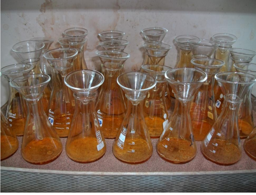
Şekil 4.5 Çeker ocakta yakma işlemi.
