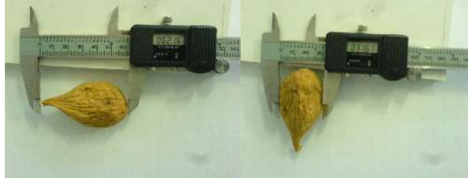
Şekil 4.1. Doğal uzunluk ve genişlik ölçümleri
