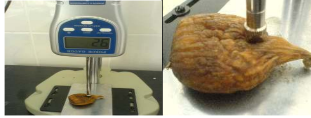
Şekil 4.8. Kesilme kuvveti ölçümü
