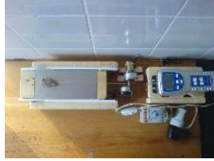
Şekil 3.3. Sürtünme direnci ölçüm düzeneği
