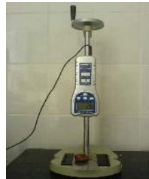
Şekil 3.4. Lutron F-G 5005 dinamometre, FS-1001 standına ve RS-232 bilgisayar bağlantı kablosu
