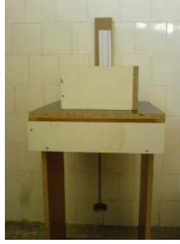
Şekil 3.1. Doğal yığılma açısı ölçüm düzeneği
