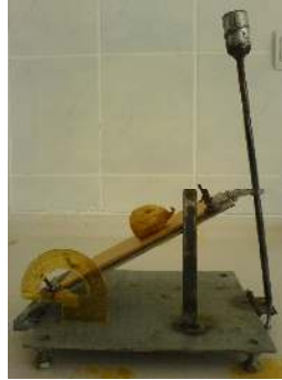
Şekil 3.2. Yuvarlanma direnci ölçüm düzeneği
