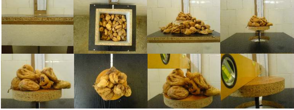
Şekil 4.4. Doğal yığılma açısı ölçüm düzeneği
