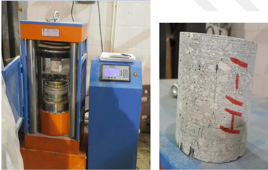
Şekil 3.15. Karot numunelerin basınç dayanım testi
