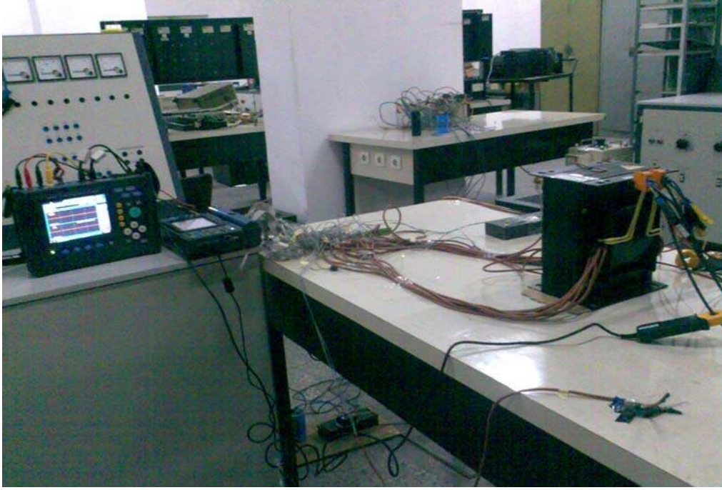
Resim 4.4. 3 KVA lık kuru tip güç transformatörü için kurulan deney seti
