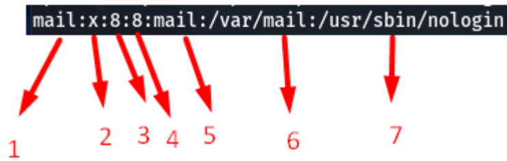
Şekil 4.4. etc/passwd dosyasında bulunan kullanıcı bilgisi formatı örneği
