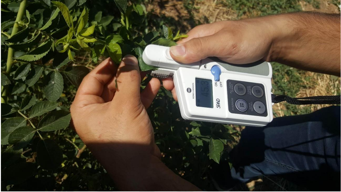
Şekil 3.8. SPAD (konicaminolta SPAD-502 plus) cihazı ile klorofil ölçümü (Orijinal. Taha KARADAĞ/2022)
