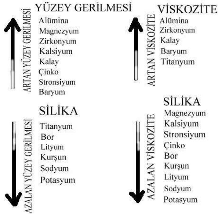
Şekil 5.6. Hammaddelere bağlı olarak yüzey geriliminin ve viskozitenin değişimi [22].
