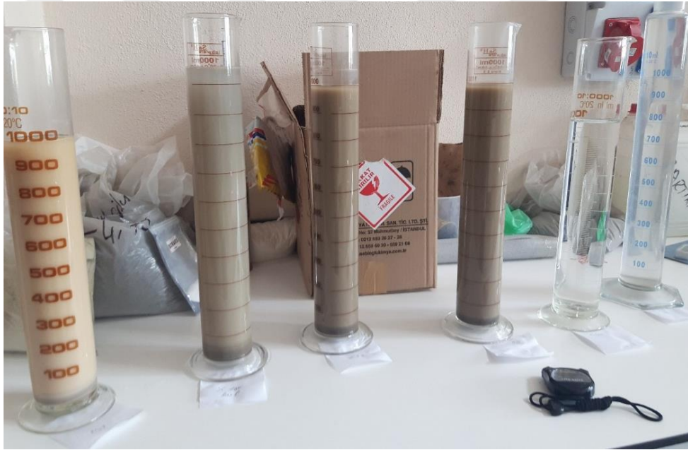
Şekil 3.4: Hidrometre deneyine ait fotoğraf.
