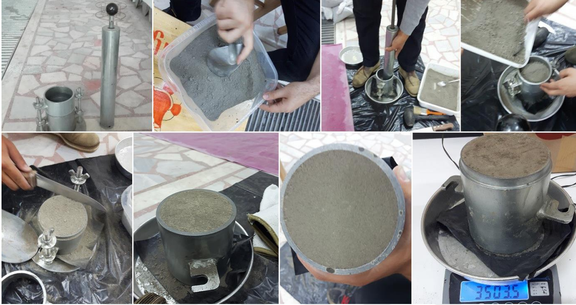
Şekil 3.11: Standart proktor deney görüntüleri.
