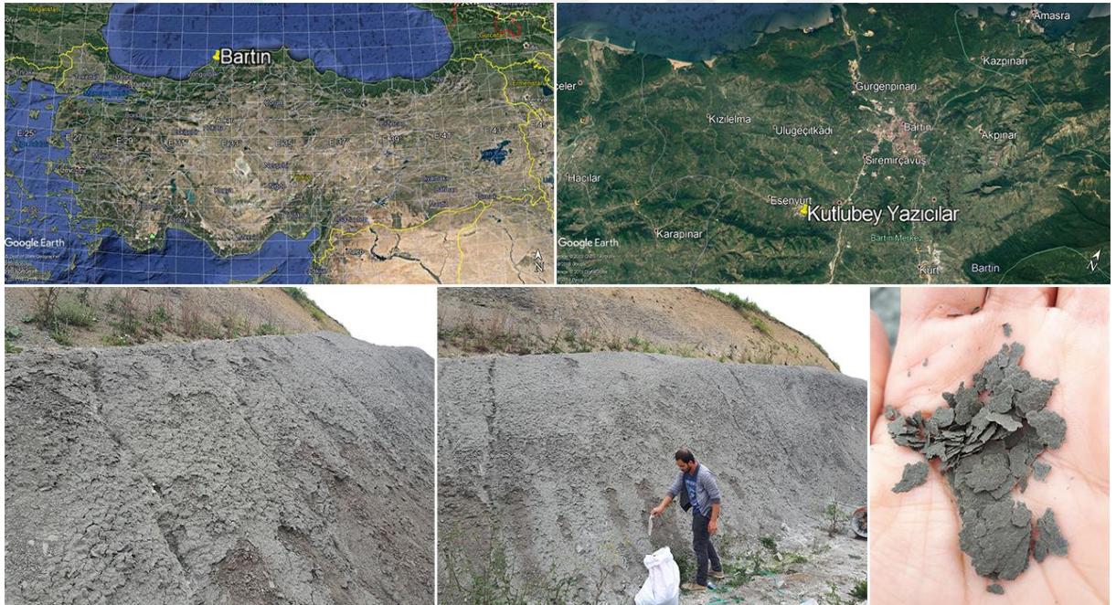
Şekil 3.1: Çalışma alanı yer bulduru haritaları ve çalışma alanında yer alan kil taşı birimlerinden görünüm.
