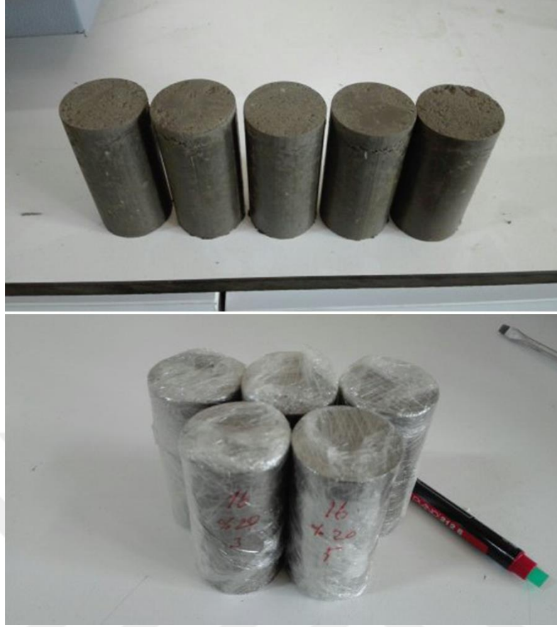
Şekil 3.15: Numunelerin kür işlemi için hazırlanması.
