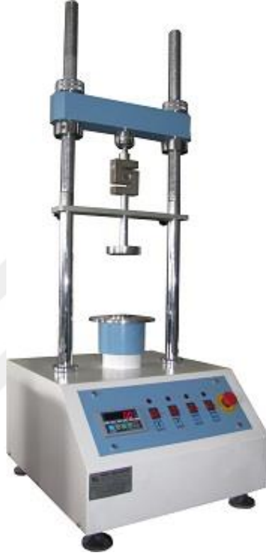
Şekil 2.13: Tek eksenli deney aleti.
