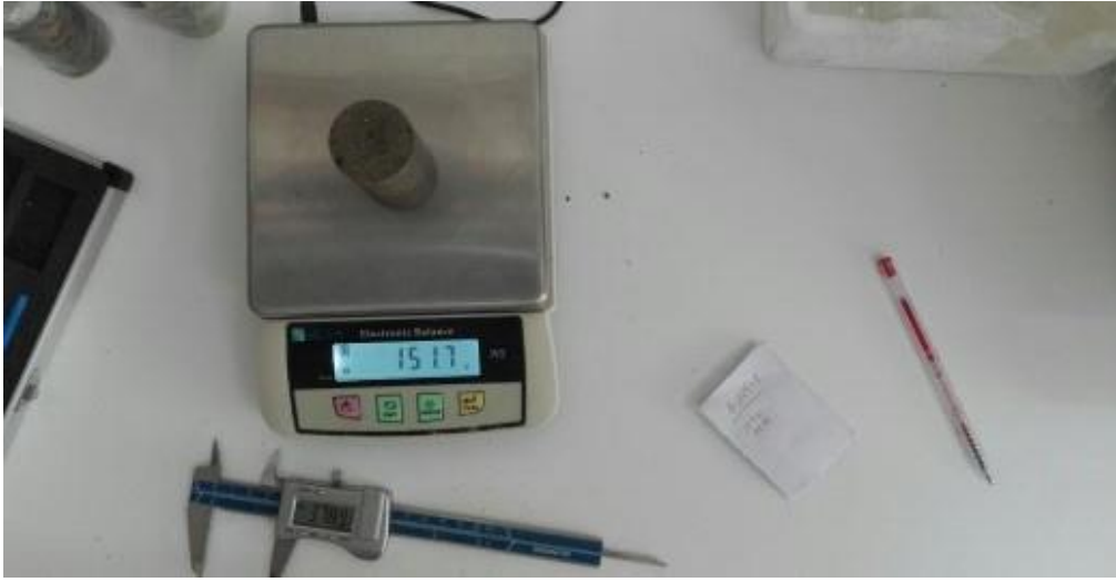
Şekil 3.18: Numunelerin çap, boy ve ağırlıklarının ölçülmesi.
