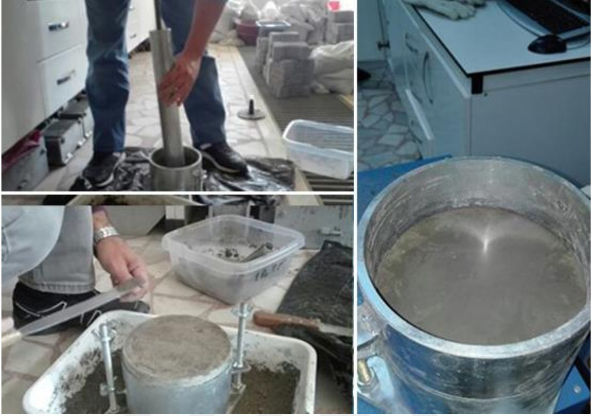
Şekil 3.13: Standart enerjiyle sıkıştırılan kalıplar.
