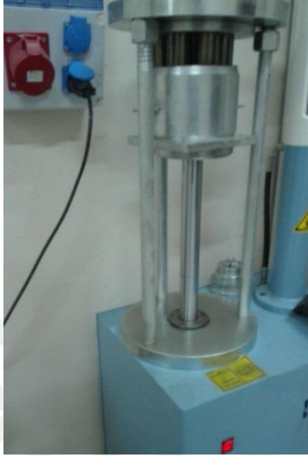
Şekil 3.14: Numune alıcıların kalıba batırılması.
