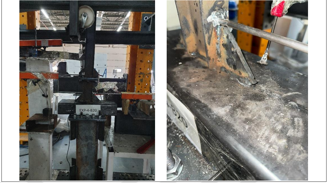
Şekil 4.15. Göçme modları (B-20 numunesi)
