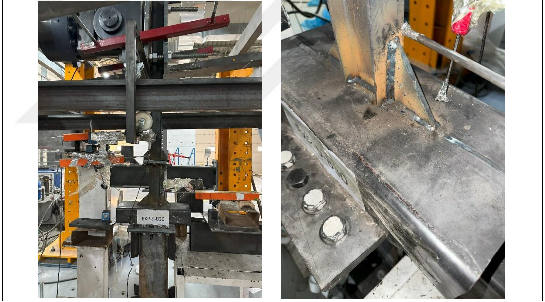
Şekil 4.16. Göçme modları (B-30 numunesi)
