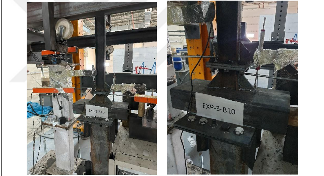
Şekil 4.14. Göçme modları (B-10 numunesi)
