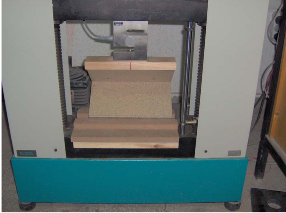
Resim 11.1. Yonga levhanın diyagonal basınç deneyi anındaki durumu
