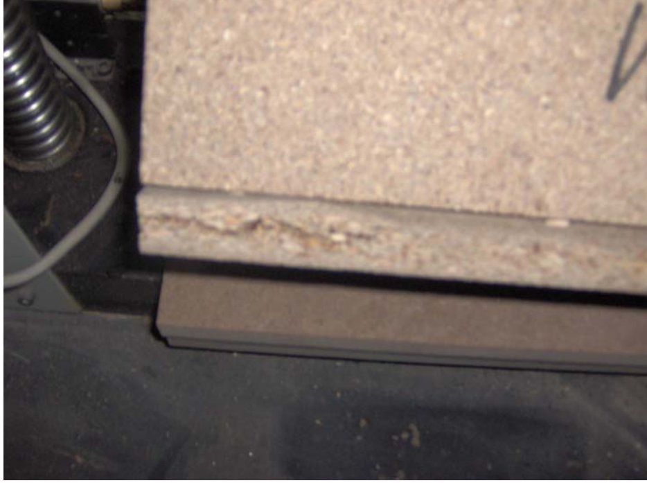
Resim 20.1. Yonga levhanın diyagonal basınç deneyi sonrası deformasyonu
