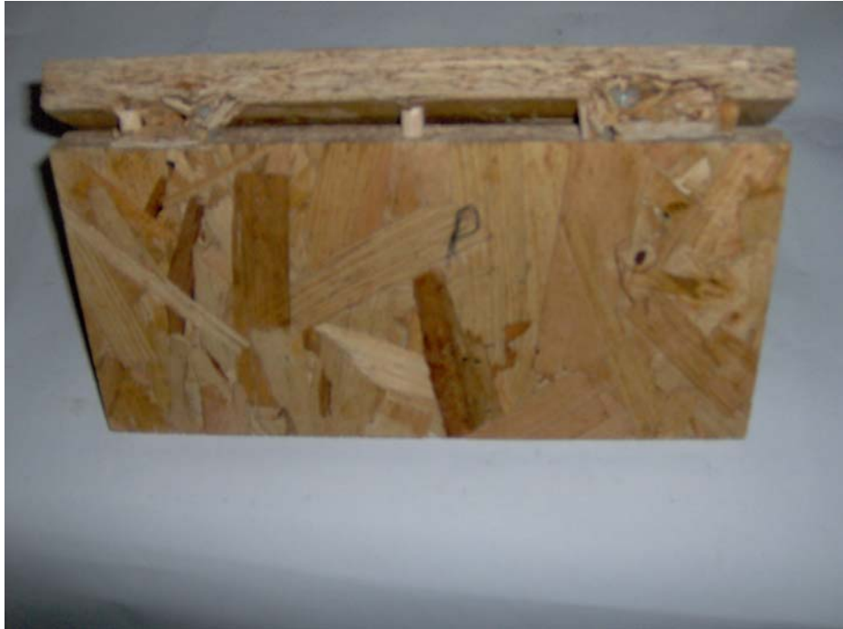
Resim 16.2. OSB'nin diyagonal basınç deneyi sonrası deforme olmuş durumu
