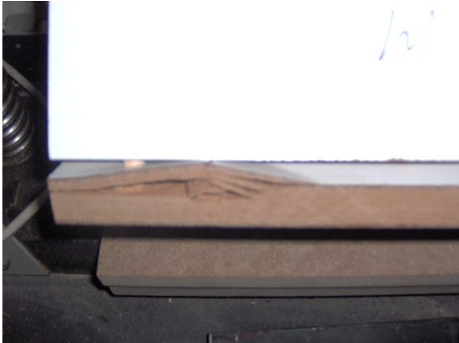
Resim 21.2. MDF laminin diyagonal basınç deneyi sonrası deformasyonu
