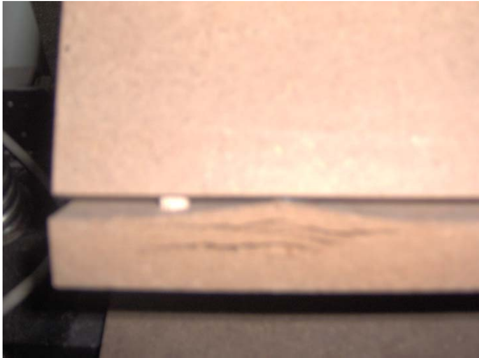
Resim 20.2. Lif levhanın diyagonal basınç deneyi sonrası deformasyonu
