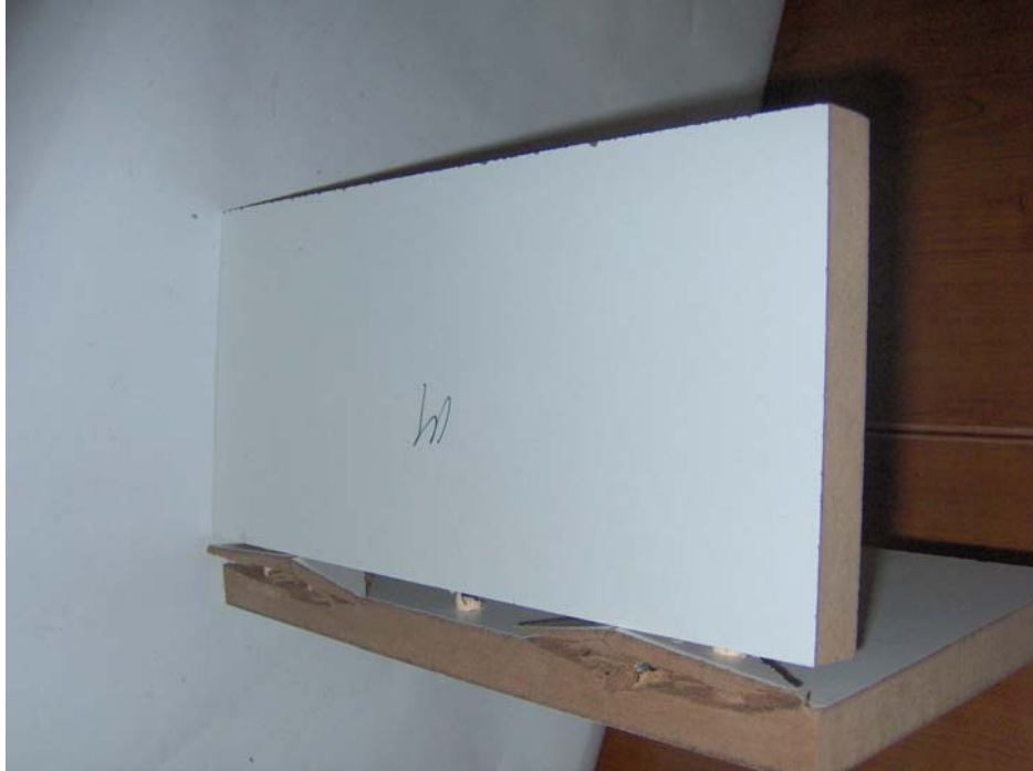
Resim 14.2. MDF lamin diyagonal basınç deneyi sonrası deforme olmuş durumu
