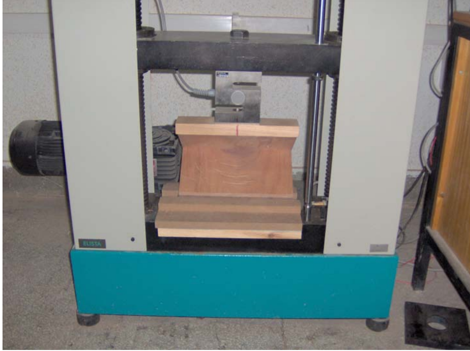
Resim 4.1. Diyagonal basınç deneyleri düzeneğinin önden görünüşü
