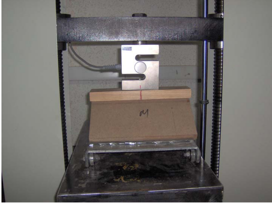
Resim 6.1. Lif levhanın diyagonal çekme deneyi anındaki durumu
