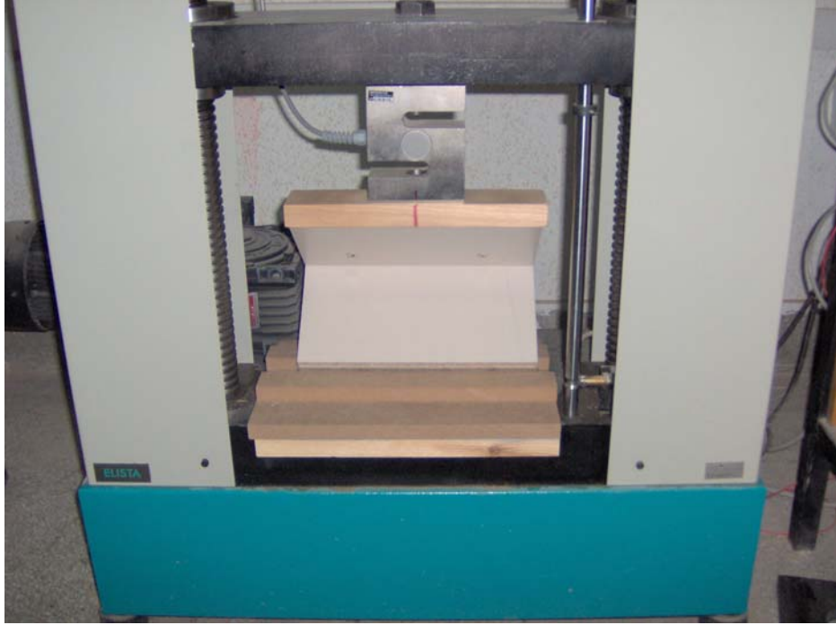
Resim 13.1. Suntalamın diyagonal basınç deneyi anındaki durumu
