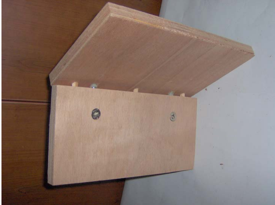
Resim 9.2. Kontrplakın diyagonal çekme deneyi sonrası deforme olmuş durumu
