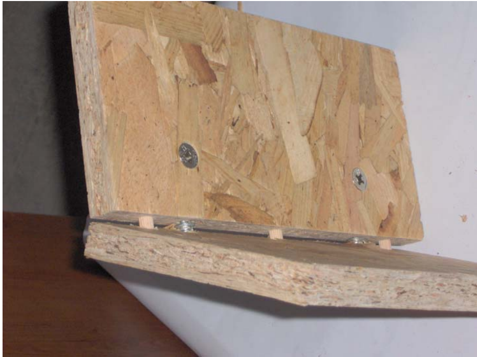
Resim 19.2. OSB'nin diyagonal çekme deneyi sonrası deformasyonu
