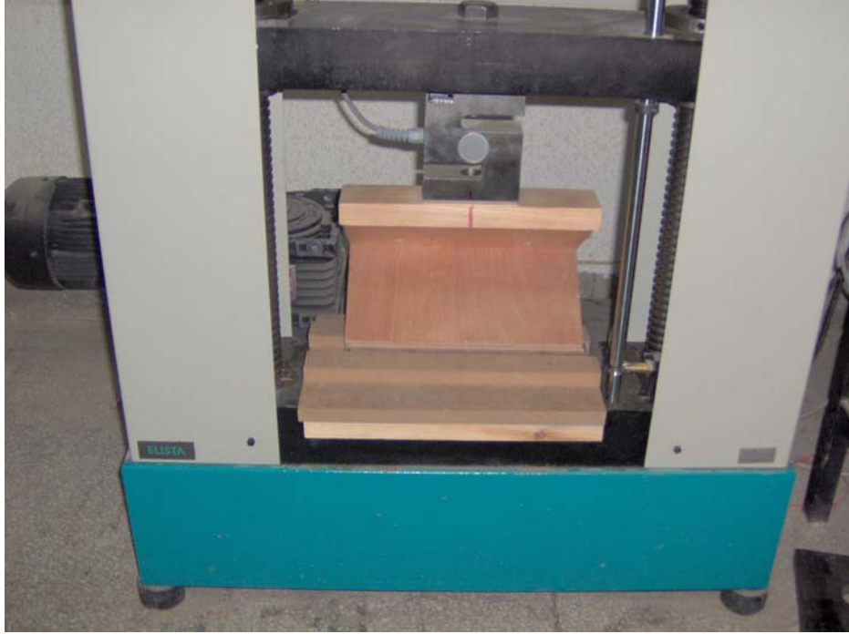
Resim 15.1. Kontrplakın diyagonal basınç deneyi anındaki durumu
