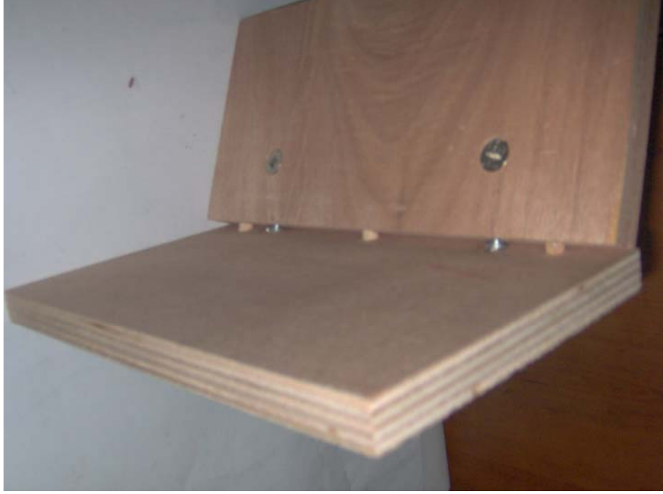
Resim 19.1. Kontrplakın diyagonal çekme deneyi sonrası deformasyonu
