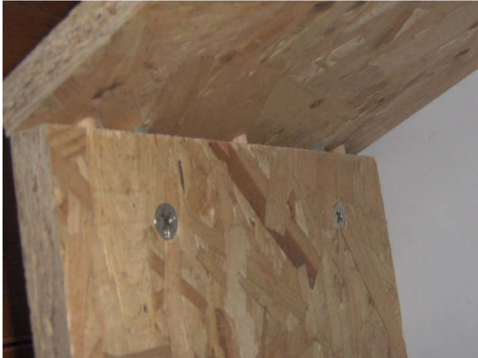
Resim 10.2. OSB'nin diyagonal çekme deneyi sonrası deforme olmuş durumu
