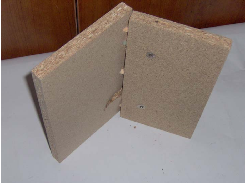
Resim 5.2. Yonga levhanın diyagonal çekme deneyi sonrası deforme olmuş durumu
