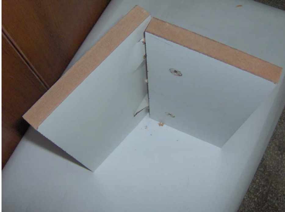
Resim 8.2. MDF lamin diyagonal çekme deneyi sonrası deforme olmuş durumu
