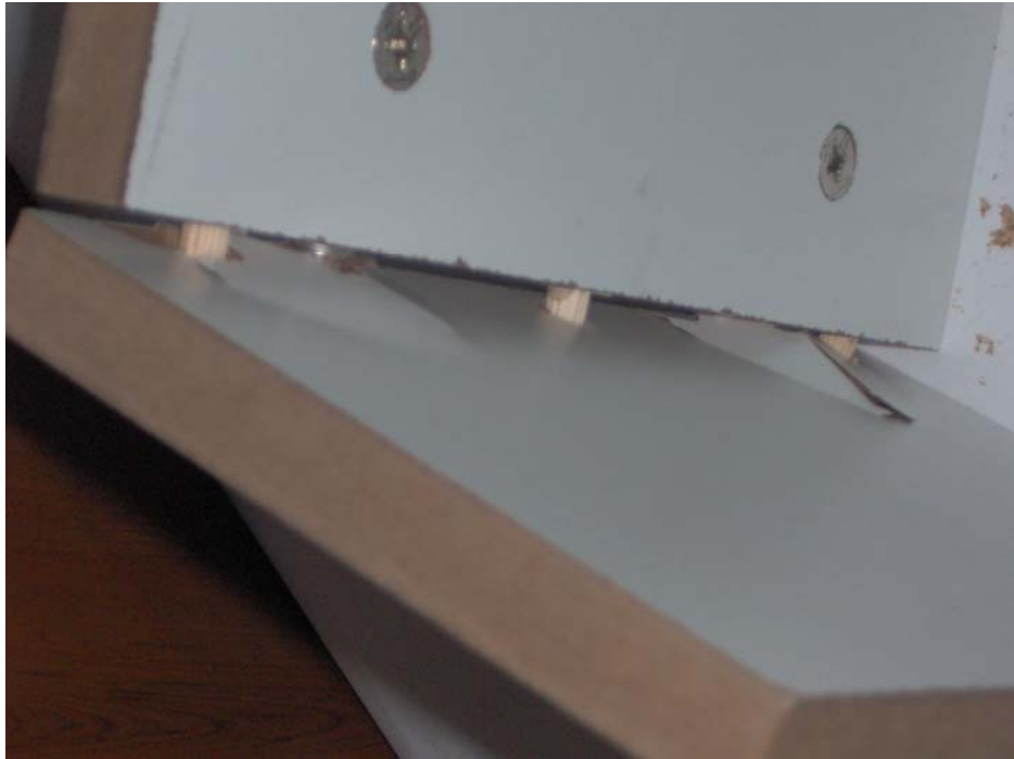
Resim 18.2. MDF laminin diyagonal çekme deneyi sonrası deformasyonu
