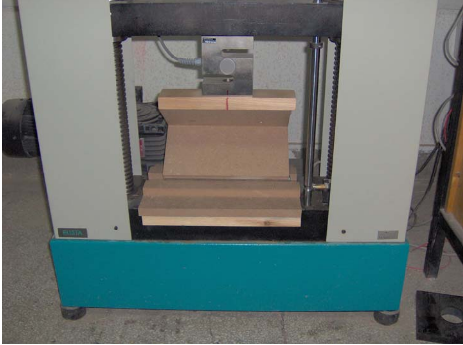
Resim 12.1. Lif levhanın diyagonal basınç deneyi anındaki durumu
