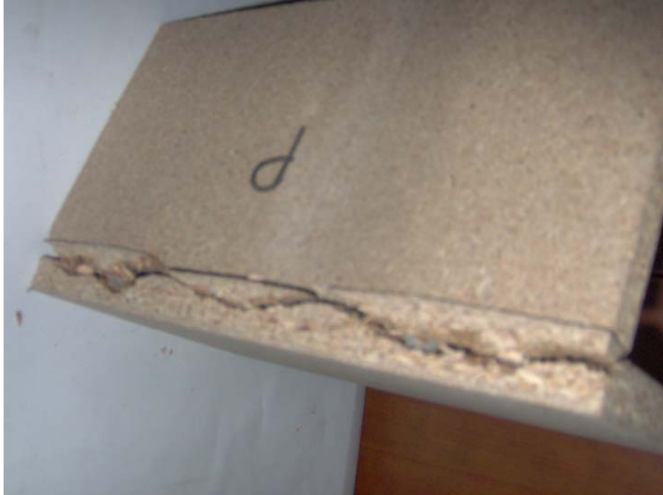
Resim 11.2. Yonga levhanın diyagonal basınç deneyi sonrası deforme olmuş durumu
