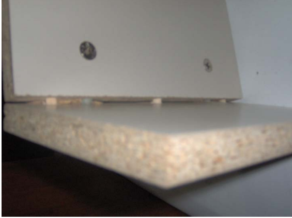
Resim 18.1. Suntalamın diyagonal çekme deneyi sonrası deformasyonu
