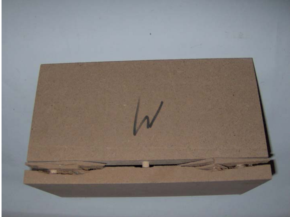
Resim 12.2. Lif levhanın diyagonal basınç deneyi sonrası deforme olmuş durumu
