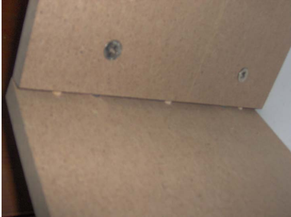
Resim 6.2. Yonga levhanın diyagonal çekme deneyi sonrası deforme olmuş durumu
