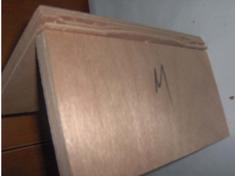
Resim 15.2. Kontrplakın diyagonal basınç deneyi sonrası deforme olmuş durumu
