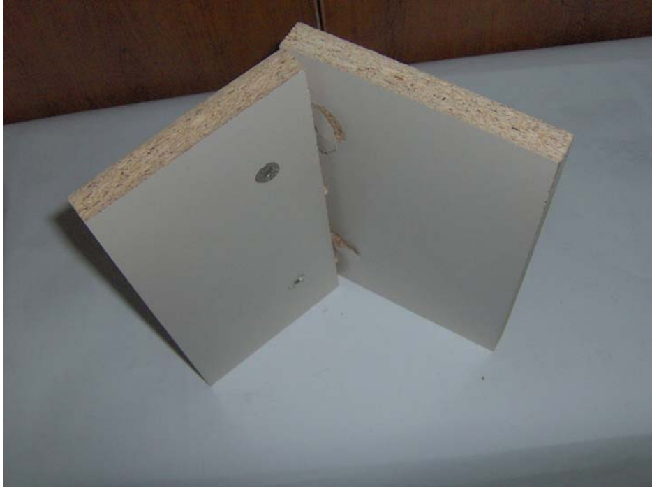
Resim 7.2. Suntalamın diyagonal çekme deneyi sonrası deforme olmuş durumu
