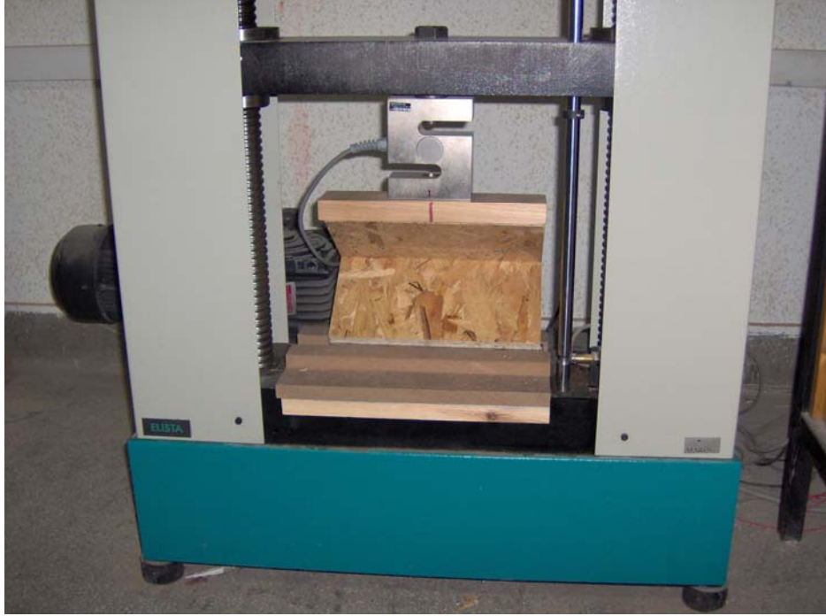
Resim 16.1. OSB'nin diyagonal basınç deneyi anındaki durumu
