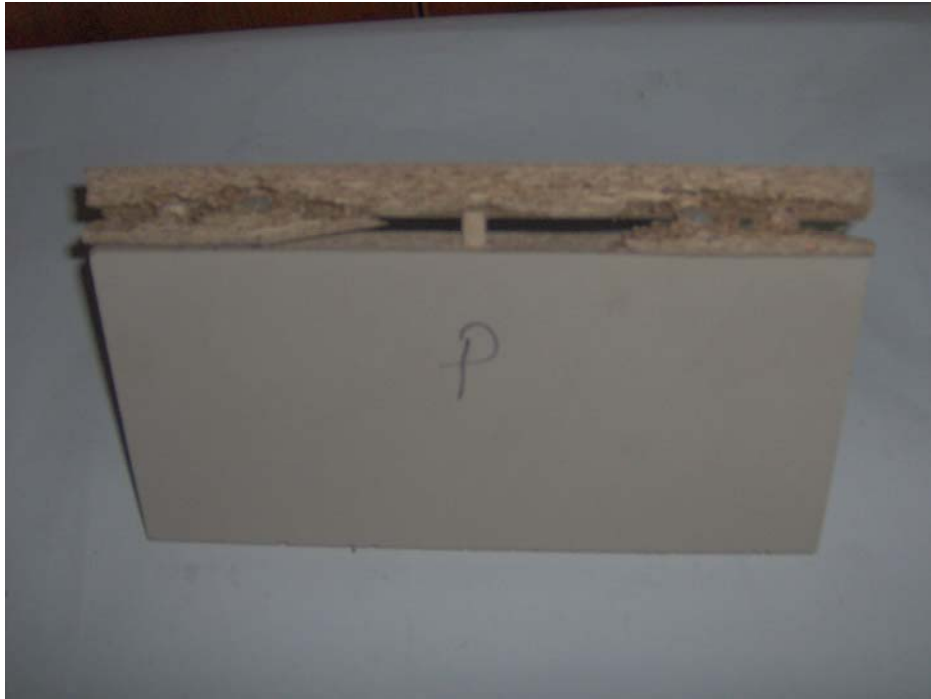
Resim 13.2. Suntalamın diyagonal basınç deneyi sonrası deforme olmuş durumu
