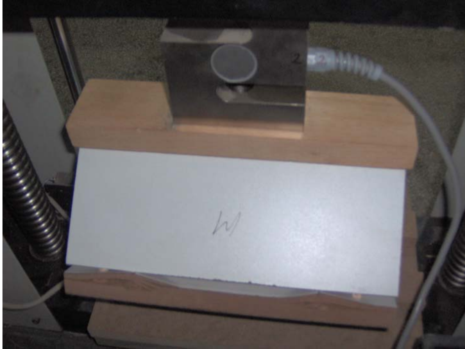
Resim 4.2. Diyagonal basınç deneyleri düzeneğinin arkadan görünüşü
