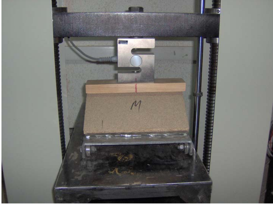
Resim 5.1. Yonga levhanın diyagonal çekme deneyi anındaki durumu
