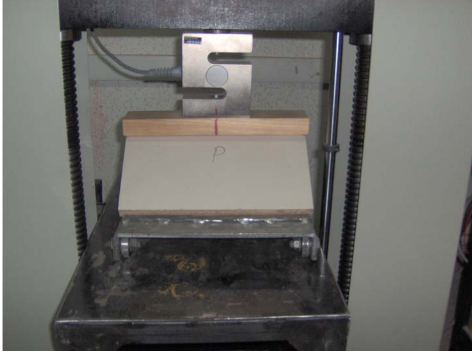
Resim 7.1. Suntalamın diyagonal çekme deneyi anındaki durumu
