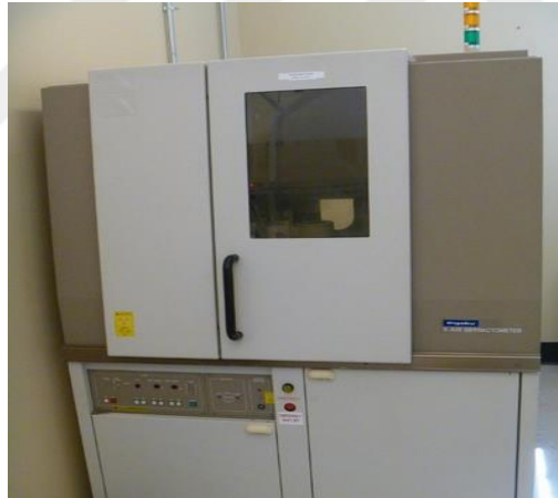
Şekil 6.4. Rigaku marka D/MAX 2000 model X-Işınları cihazı.
