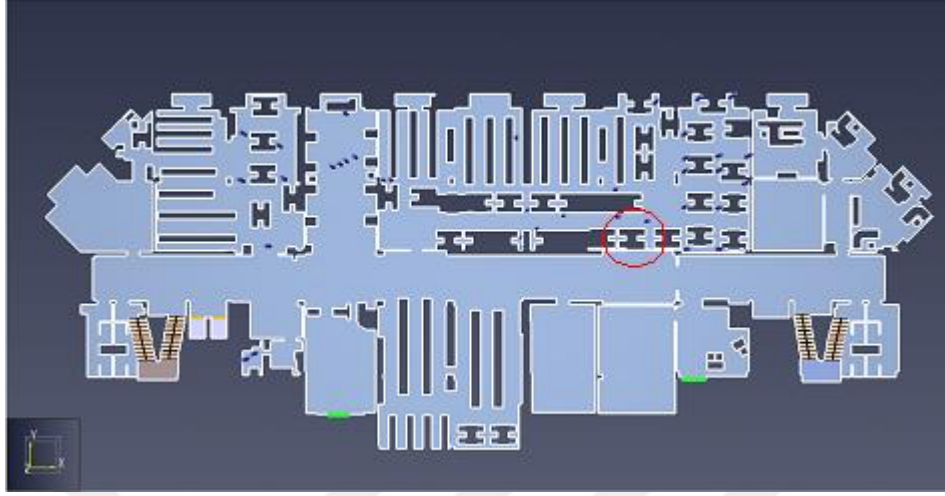
Şekil 7.11. Geçiş güzergahındaki masanın kaldırılması
