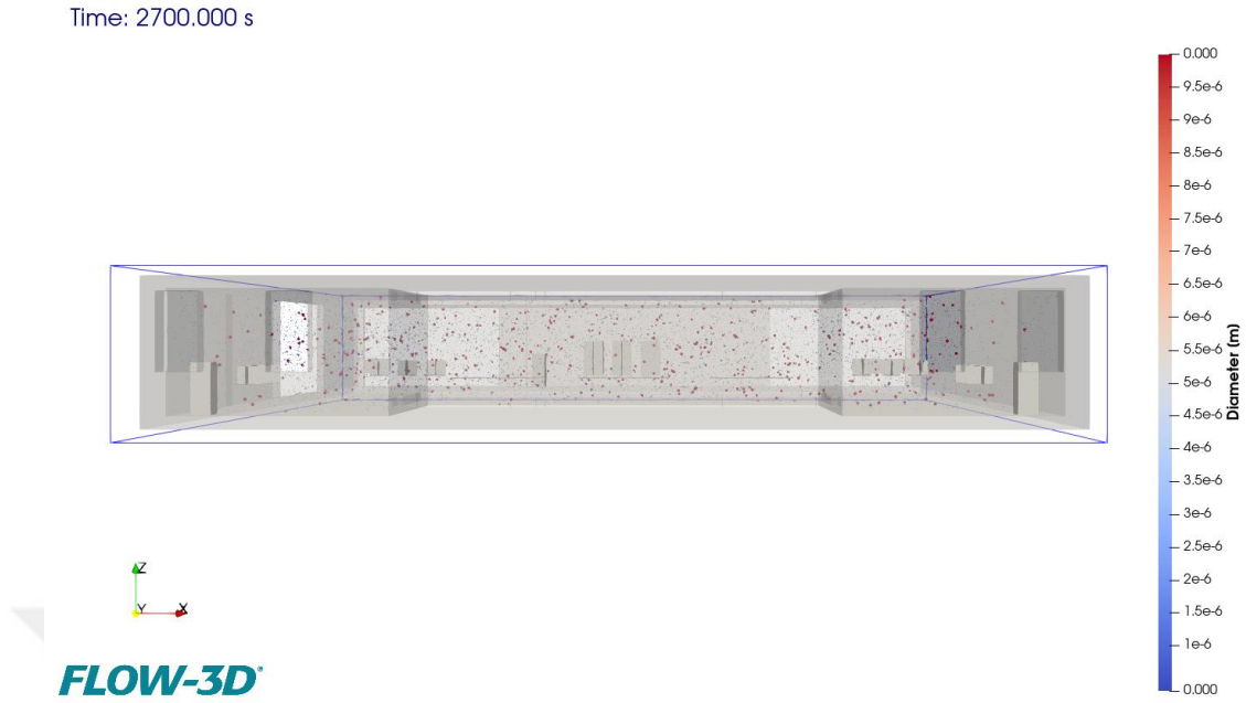
Şekil 4. 34. Akdeniz Üniversitesi Kütüphanesi, kat 2 — PM konsantrasyon dağılımı, T=2700 sn (Flow-3D simülasyonu)
