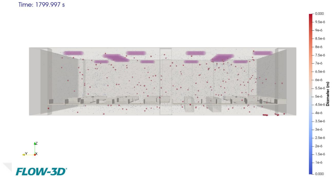
Şekil 4. 13. Antalya Kütüphanesi, oda 1 — PM konsantrasyon dağılımı, T=1800 sn (Flow-3D simülasyonu)
