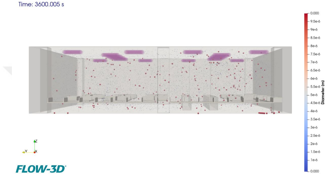
Şekil 4. 15. Antalya Kütüphanesi, oda 1 — PM konsantrasyon dağılımı, T=3600 sn (Flow-3D simülasyonu)
