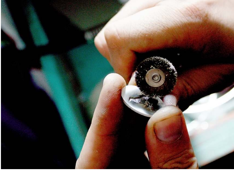
Resim 4.13. Tel Fırça ile temizleme
