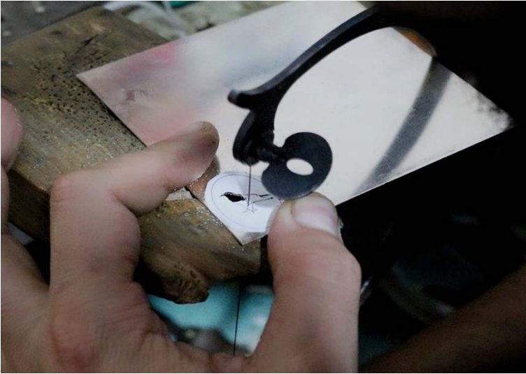
Resim 4.8. Kıl testeresi ile desenin kesilme işlemi
