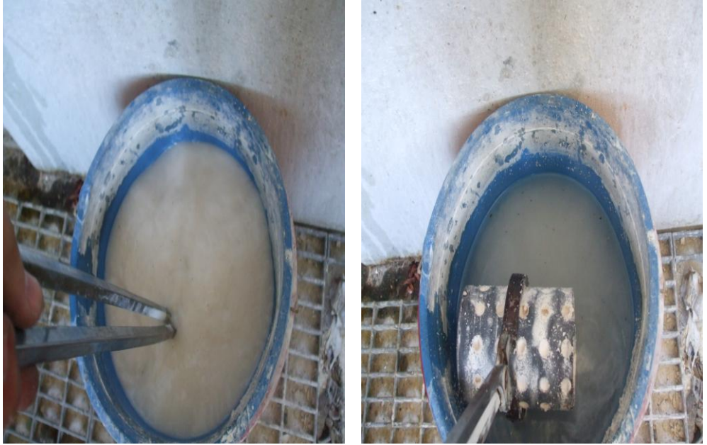
Fotoğraf 75: Döküm işlemi gerçekleştirilen fanus, alçılarından temizlenmesi için sıcakken soğuk suya batırılır
