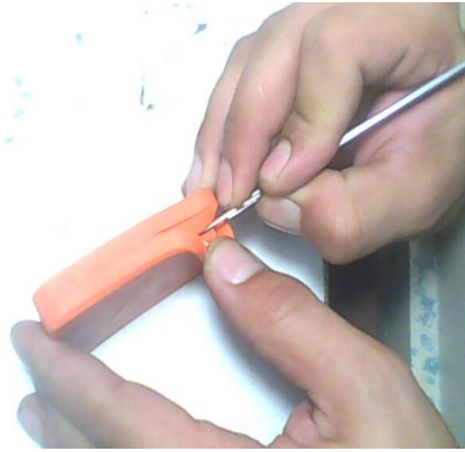
Fotoğraf 81: Neşter yardımıyla kauçuğun yolluktan başlayarak kesilme aşaması
