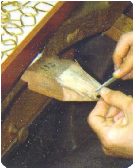
Fotoğraf 45: Döküm sonrası tesviye işlemleri, ürün eğeler yardımıyla düzeltilir, daha sonra cila makinesinde parlatılıp son şekli verilir
