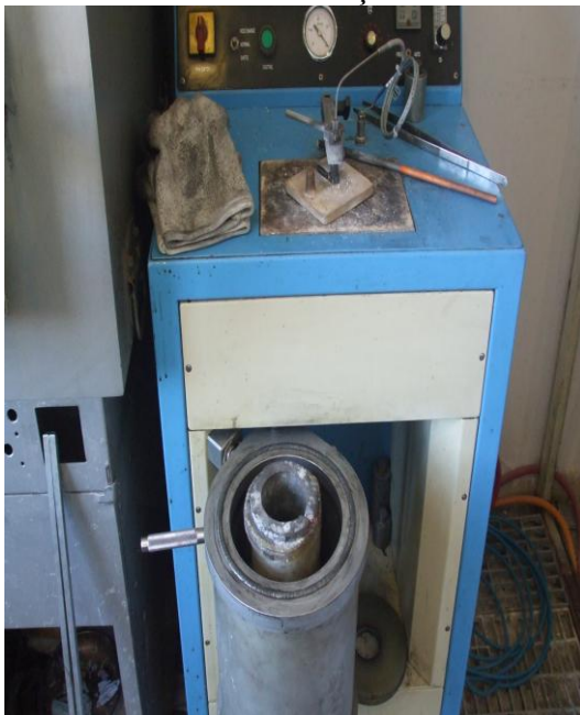
Fotoğraf 72: Oluklu şiddeden alınan çubuk halindeki gümüşlerin döküm makinesine eritilmek üzere atılması işlemi
