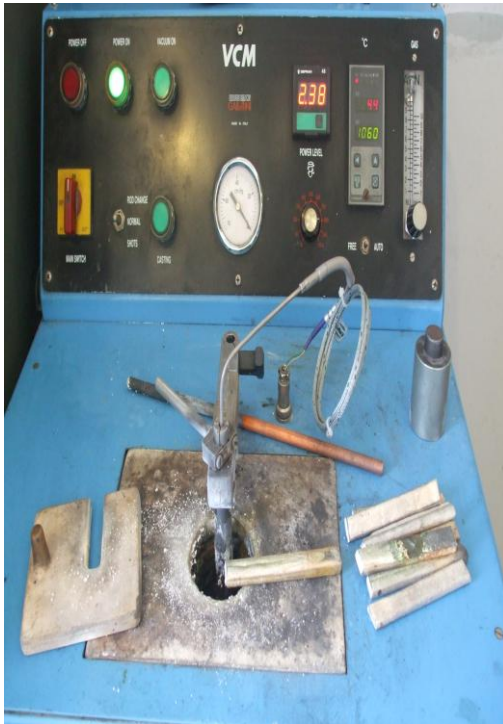
Fotoğraf 72: Oluklu şiddeden alınan çubuk halindeki gümüşlerin döküm makinesine eritilmek üzere atılması işlemi
