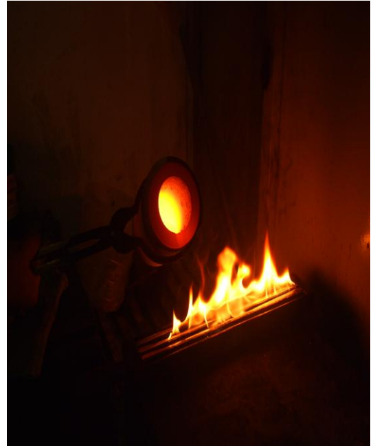
Fotoğraf 71: Eriyen gümüş potasının maşa ile alınması ve oluklu şideye dökülmesi işlemi
