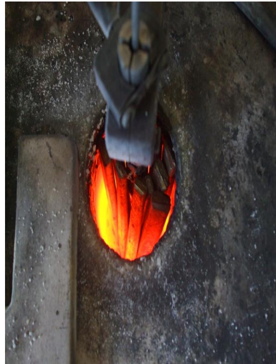
Fotoğraf 72: Oluklu şiddeden alınan çubuk halindeki gümüşlerin döküm makinesine eritilmek üzere atılması işlemi
