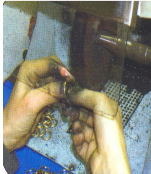
Fotoğraf 45: Döküm sonrası tesviye işlemleri, ürün eğeler yardımıyla düzeltilir, daha sonra cila makinesinde parlatılıp son şekli verilir
