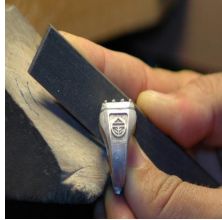
Fotoğraf 56: Hassas döküm sonrası gümüş model tesviye ediliyor
