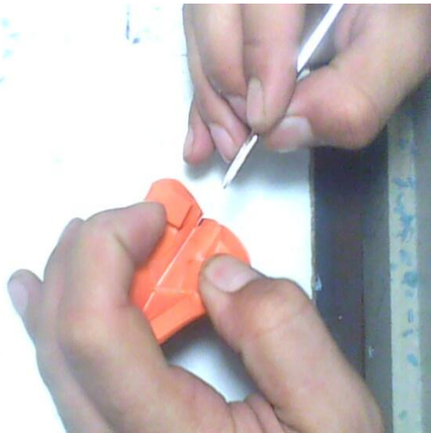
Fotoğraf 82: Kauçuğun üst kısmının neşterle kesilme aşaması
