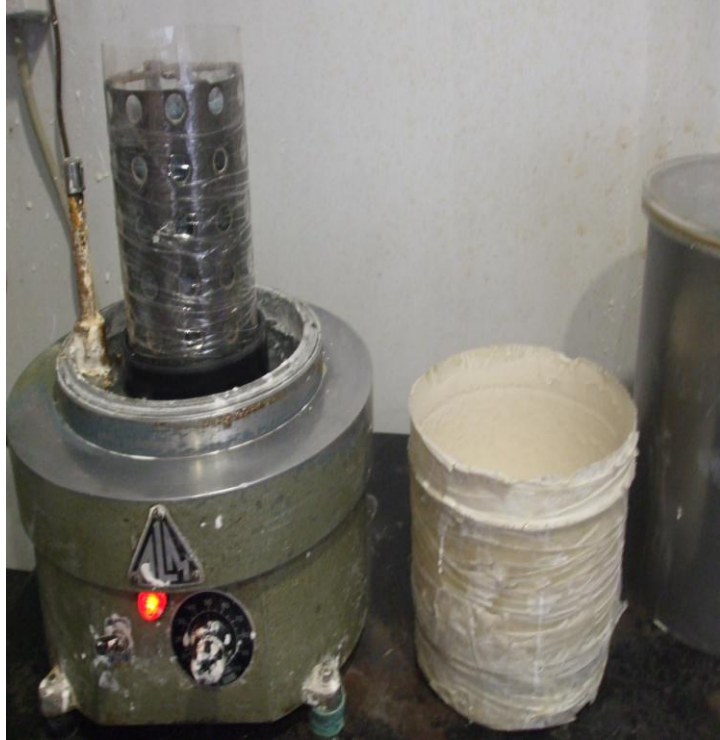
Fotoğraf 64: Dizme işlemi bitirilen modellerin olduğu mum ağacının fanusa yerleştirilmesi işlemi
