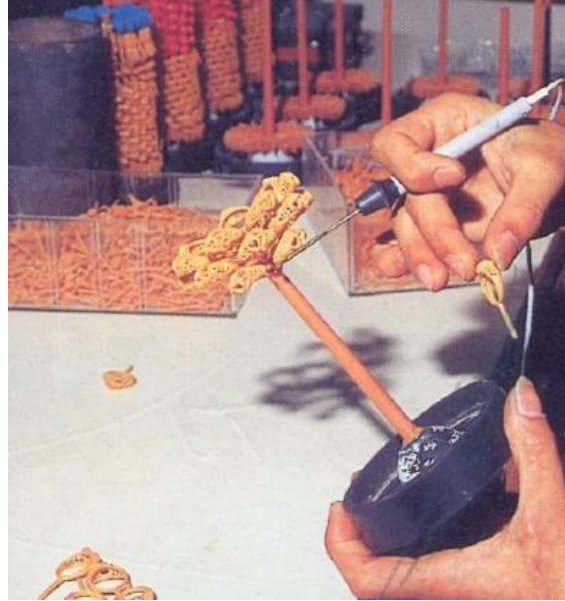
Fotoğraf 21: Mum havyası ile mum ağacına mum modellerin dizilmesi işlemi
