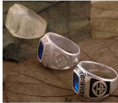
Fotoğraf 58 : 3D Printer modeline bağlı olarak yapılan imalat aşamaları bir arada görülüyor
