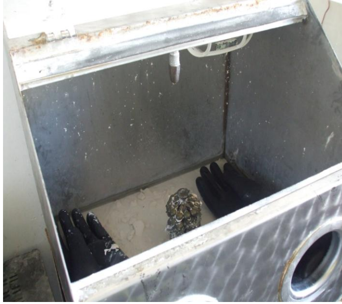
Fotoğraf 76: Suya batırma işleminden sonra modellerde kalan alçının iyice temizlenmesi için alçı temizleme makinesinde basınçlı su uygulanması işlemi
