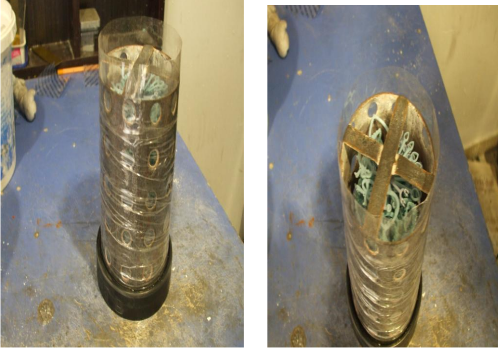
Fotoğraf 64: Dizme işlemi bitirilen modellerin olduğu mum ağacının fanusa yerleştirilmesi işlemi
