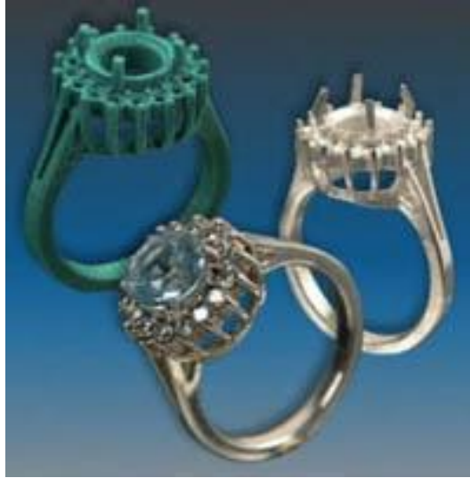
Fotoğraf 47: ModelMaker da çizilmiş yüzüğün mum, döküm ve bitmiş hali
