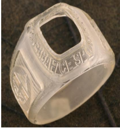
Fotoğraf 55: Master Model (Malzeme: fotopolimer reçine)
