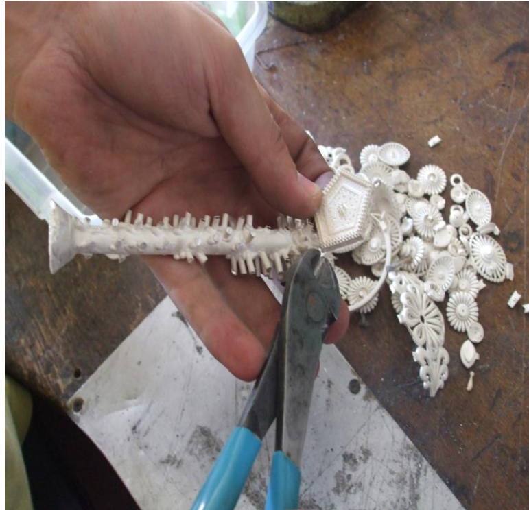
Fotoğraf 79: Asitleme işleminden sonra modeller tesviye yapılmak üzere ağaçtan makas yardımıyla ayrılır.
