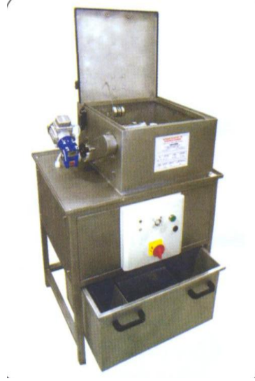
Fotoğraf 36: Basıncılı suyla otomatik alçı temizleme makinesi
