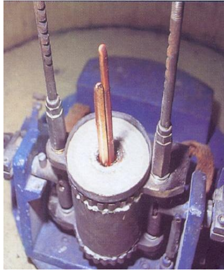
Fotoğraf 43: Metalin potaya konması işlemi, santrifüj döküm makinesi
