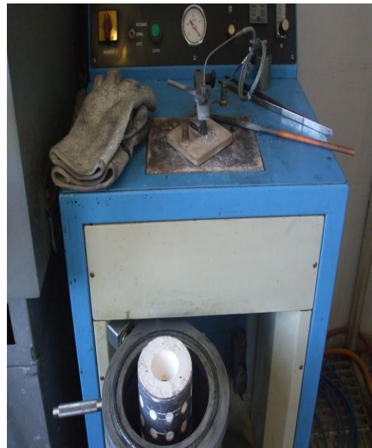
Fotoğraf 72: Oluklu şiddeden alınan çubuk halindeki gümüşlerin döküm makinesine eritilmek üzere atılması işlemi
