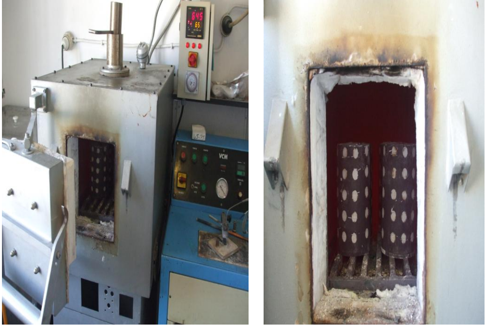
Fotoğraf 69: Alçının pişmesi için fırınlanması işlemi
