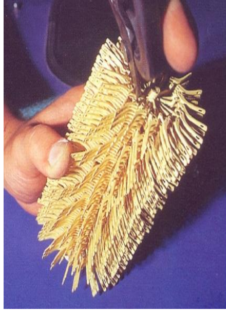
Fotoğraf 44: Dökümden çıkıp alçıları temizlenmiş ağacın tesviye için hazırlanması
