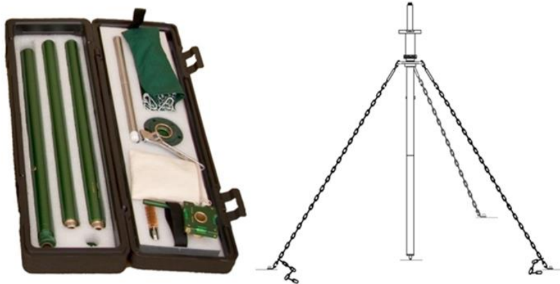
Şekil 5.6 Zincirli Tripod (Sabit yükseklikli GNSS ölçme ekipmanı).
