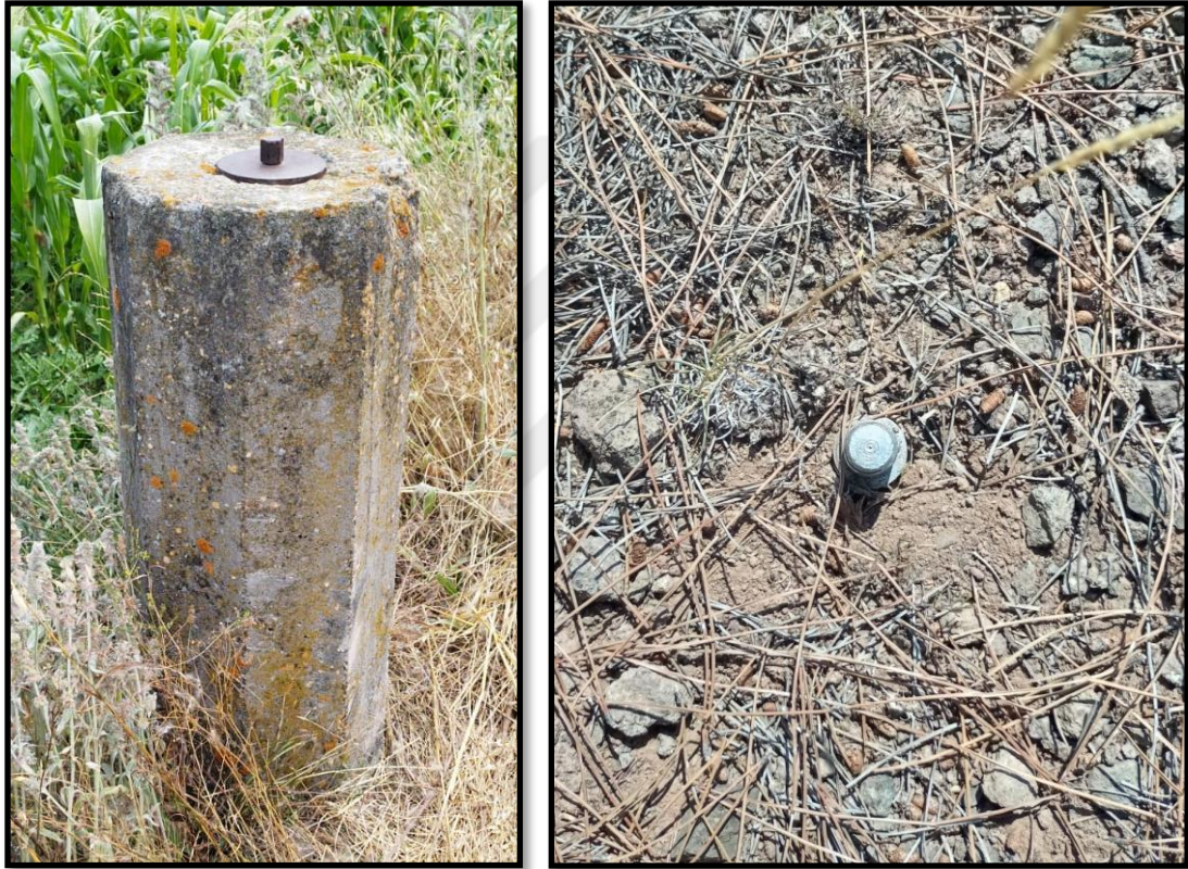
Şekil 5.3 Kampanya tipi GNSS gözlem ağı nokta tesis tipi örnekleri. Pilye (Solda), Yer noktası (Sağda).
