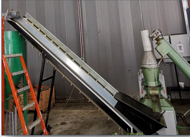
Resim 2.5. Pelet makinasından çıkan nihai ürünün depo silosuna aktarımı
