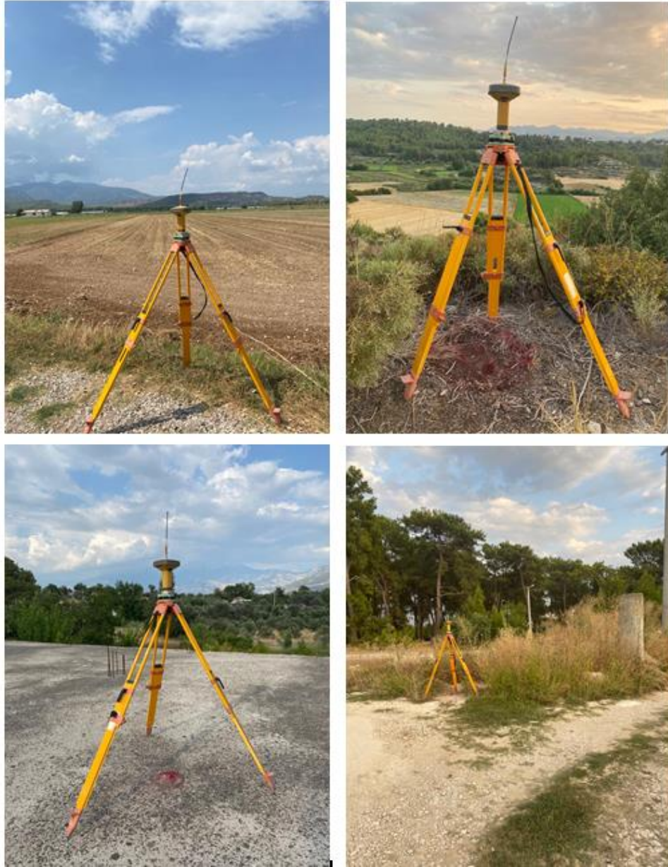
Şekil 6. 7. İkinci bölge II. çalışma alanında yapılan Ağ-RTK uygulamasından görüntüler.
