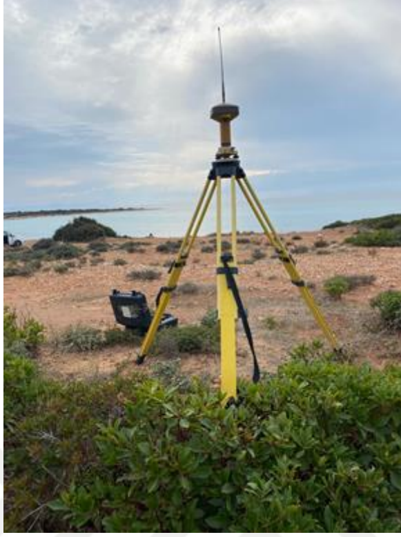
Şekil 6. 9. I. Çalışma alanındaki N3 noktasında kurulan sabit GNSS alıcısı.
