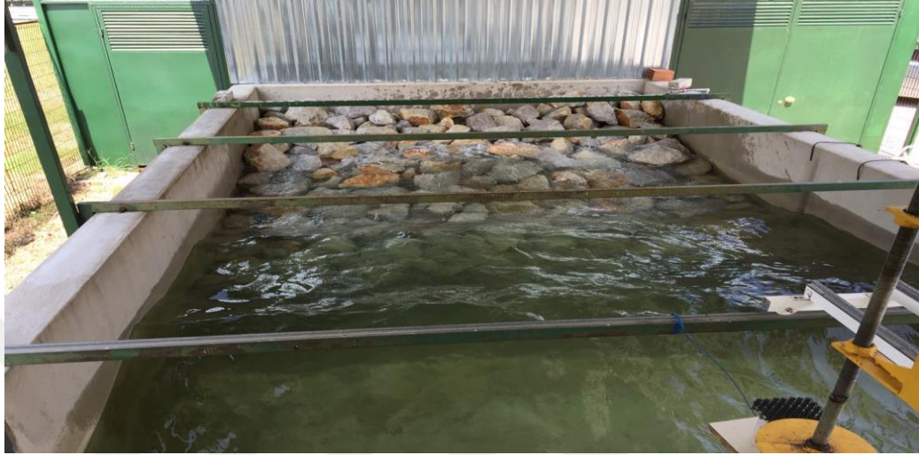
Şekil 3.3 Mengene yardımı ile sabitlenmiş kazıklar ve sönümleyici taşlar (Kişisel arşiv, 2016)
