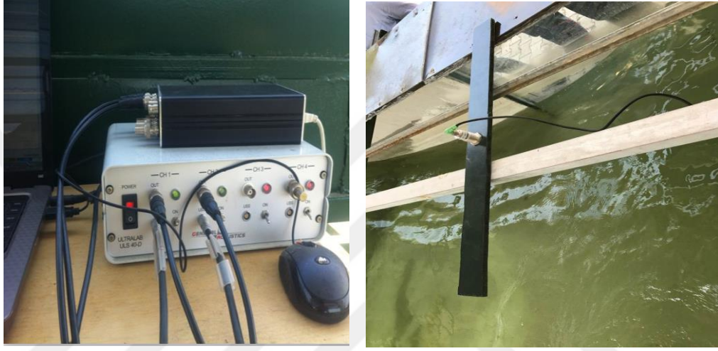
Şekil 3.7 ULS cihazı ve USS20130 algılayıcıları (Kişisel arşiv, 2018)
