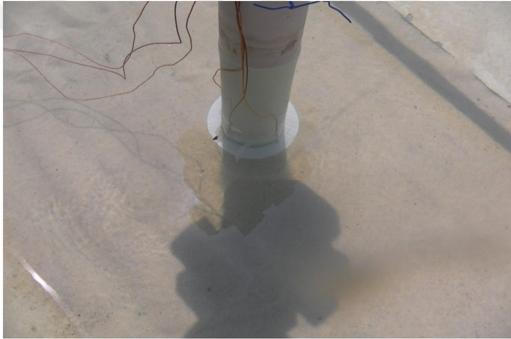
Şekil 3.24 1,5D çaplı yaka kullanılarak 160mm kazık etrafında oyulmaya karşı koruyucu önlem oluşturulması (Kişisel arşiv, 2016)
