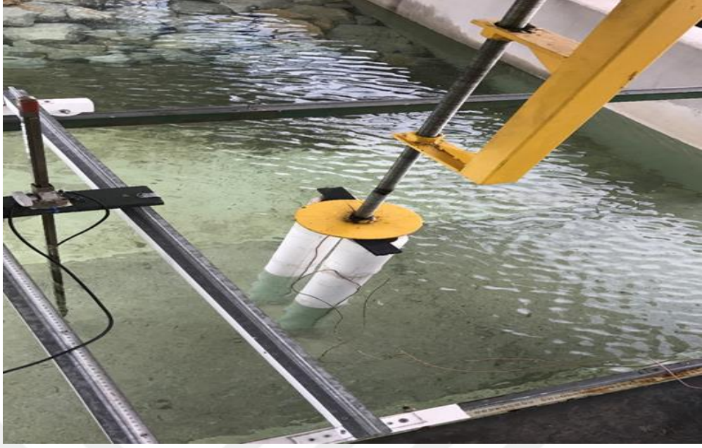
Şekil 3.20 Birbiri ardına yerleştirilen iki 110 mm kazık görünümü (Kişisel arşiv, 2016)
