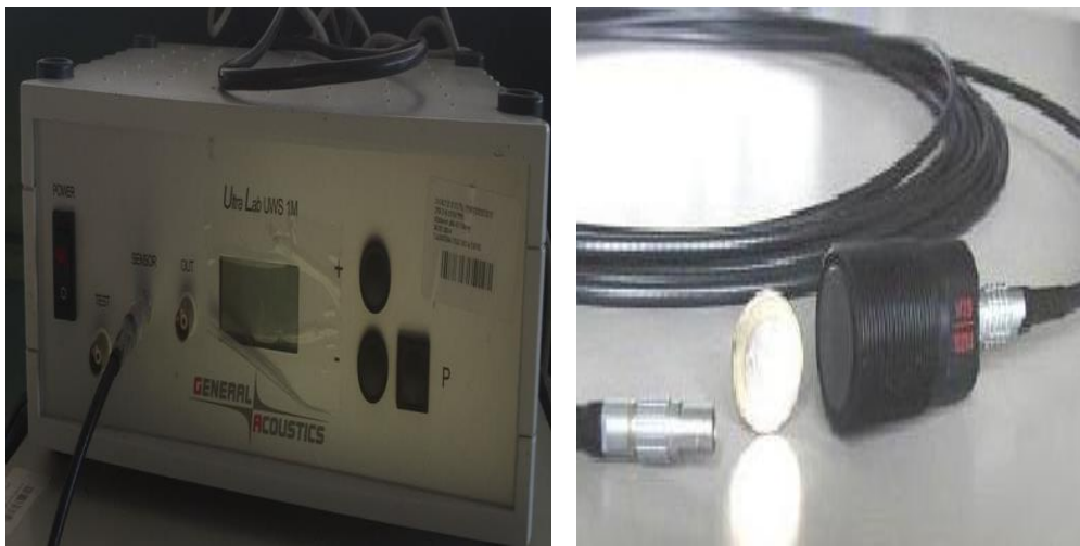
Şekil 3.9 UltraLab UWS - The Lab Echosounder cihazı ve ölçüm sensörü (Kişisel arşiv, 2018)
