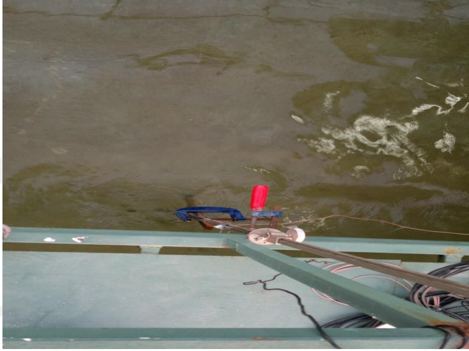
Şekil 3.16 Hız ölçümünde kullanılan UVP algılayıcısı (Kişisel arşiv, 2017)
