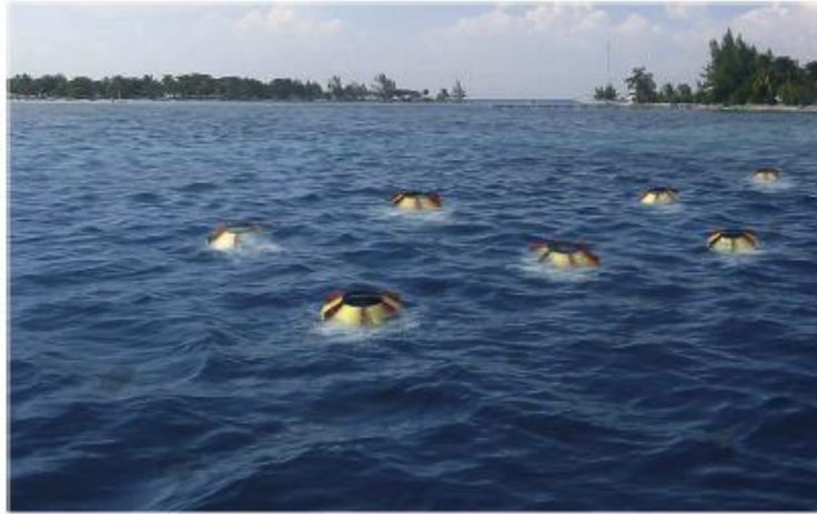
Şekil 1.17. Dairesel Rampa Aşan DEDS [9].
