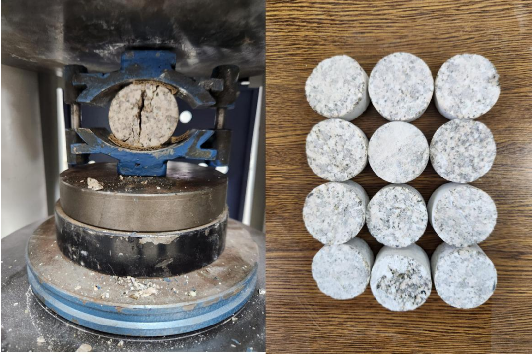
Şekil 4.1 Brazilian çekme deneyi.
