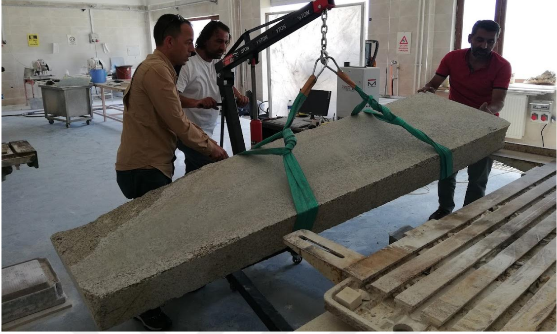
Şekil 3.24 Parçanın tezgâha yerleştirilmesi.
