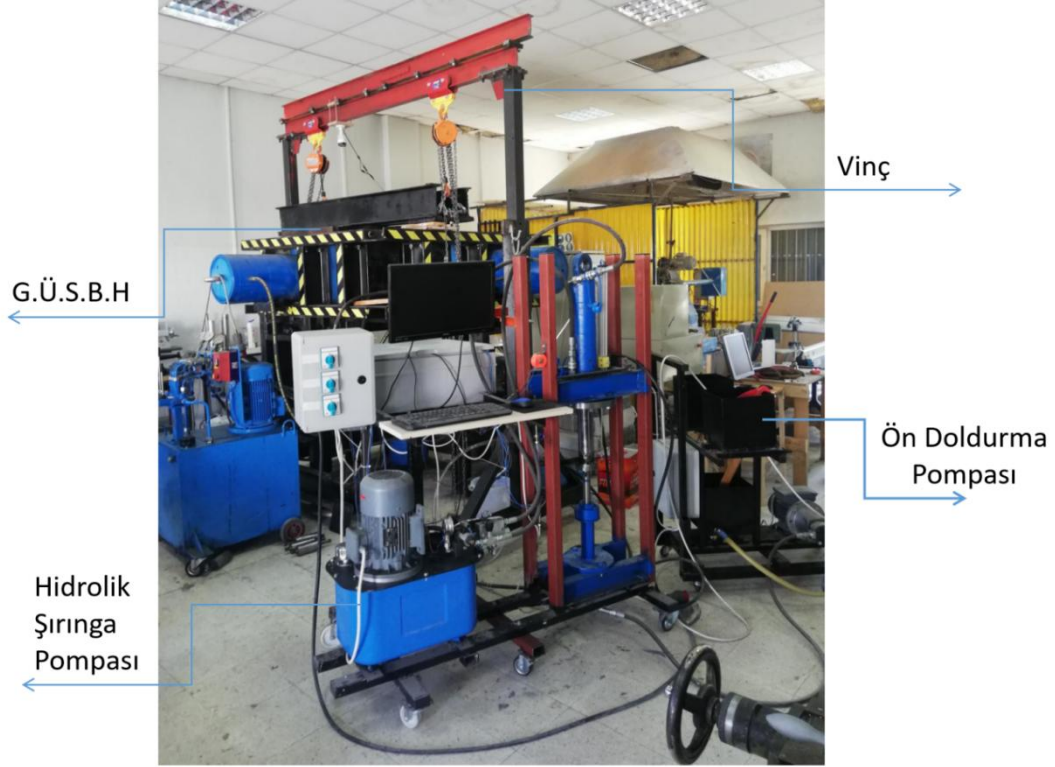
Şekil 4.4 Hidrolik çatlatma deney düzeneği.
