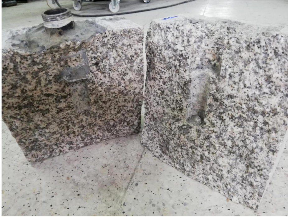
Şekil 4.22 Çatlatılmış granit numunesinin kesiti.
