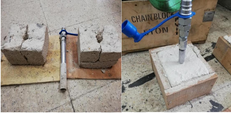
Şekil 3.10 Alçı ve beton kalıpların çatlatılması.
