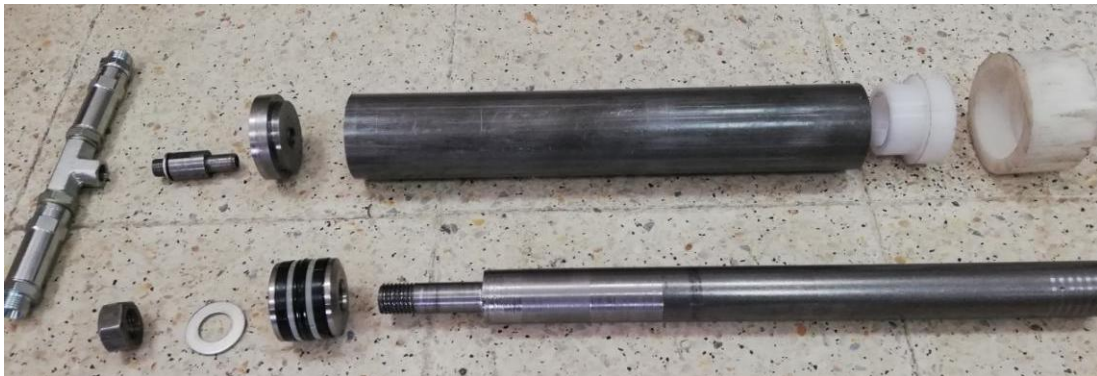
Şekil 3.9 Piston (şırınga) pompa iç parçaları.
