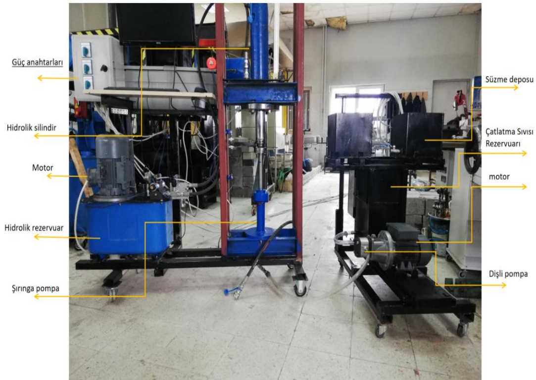
Şekil 3.3 Hidrolik çatlatma pompası.
