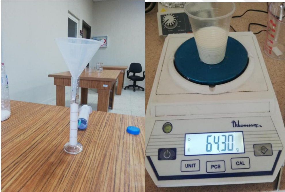
Şekil 4.16 Çatlatma sıvısı hacim ve ağırlık ölçümleri.
