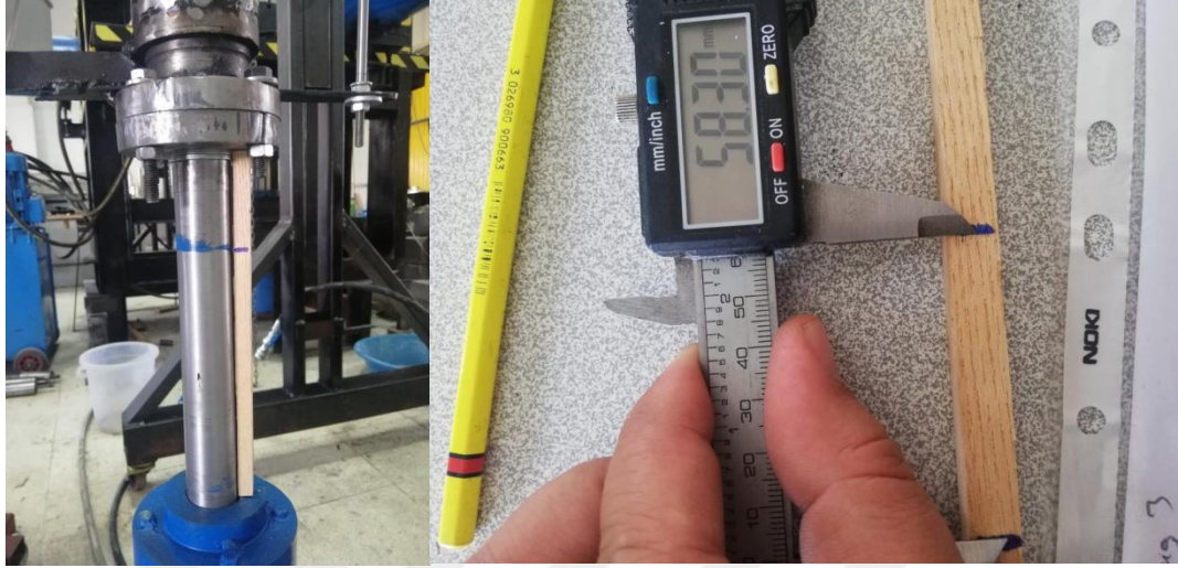
Şekil 4.12 Konum değişikliğinin elle ölçülmesi.
