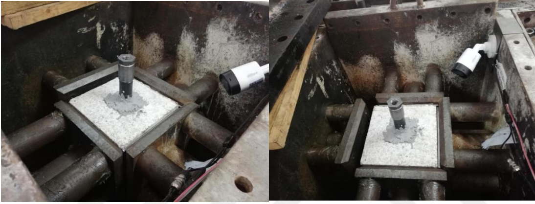
Şekil 4.6 Kayaç sıkıştırma basınç oluşturma işlemleri.
