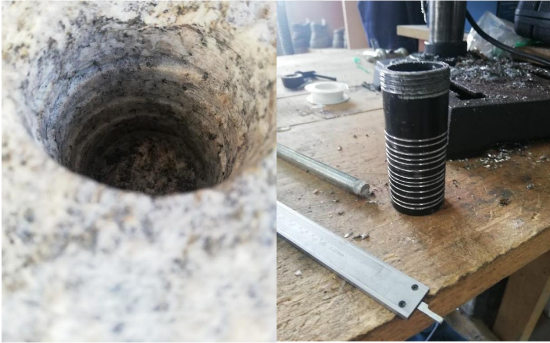
Şekil 3.29 Granit ve enjektöre açılan kanallar.
