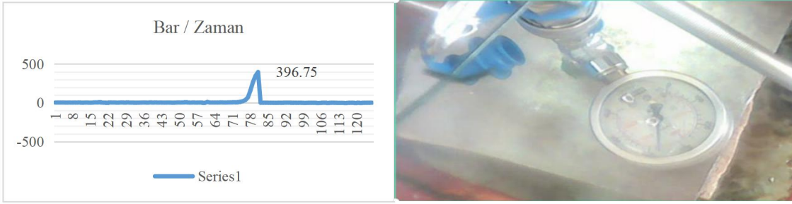
Şekil 4.20 25mm delik çaplı numunenin 396 barda çatlamasına ait basınç/zaman grafiği ve basınç saati görüntüsü.
