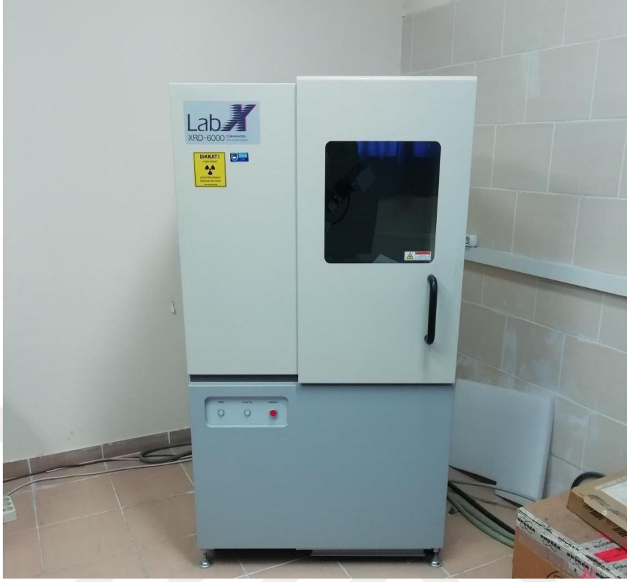
Şekil 3.37 Shimadzu XRD-6000 model X-ışını difraktometre cihazı.
