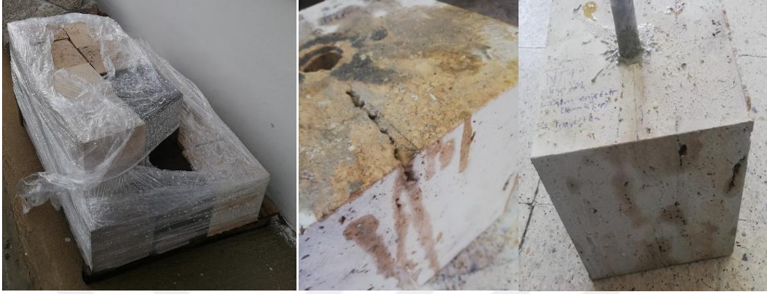
Şekil 3.22 Ön çatlatma deneylerinde kullanılan traverten örnekleri.
