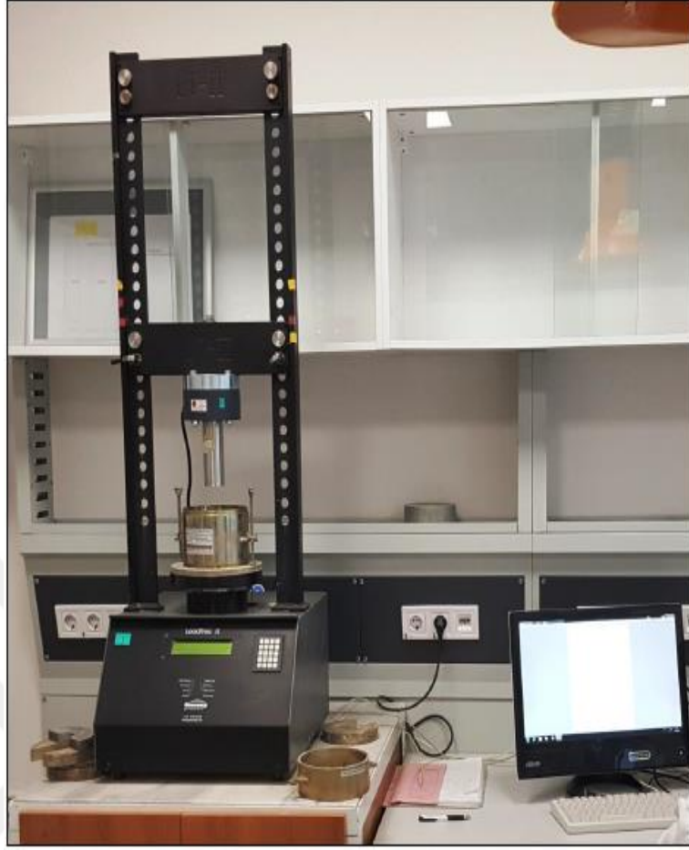
Şekil 2.17. CBR cihazı (KGM, 2021).
