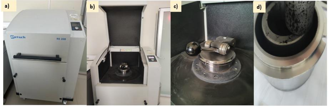
Şekil 6. a) Halkalı öğütücü dış görünüm b) iç görünüm c) öğütücü hazne d) KAC adsorbanının öğütülmesi
