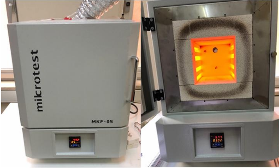
Şekil 5. Aktif karbon üretimi için özel olarak modifiye edilen fırın sistemi
