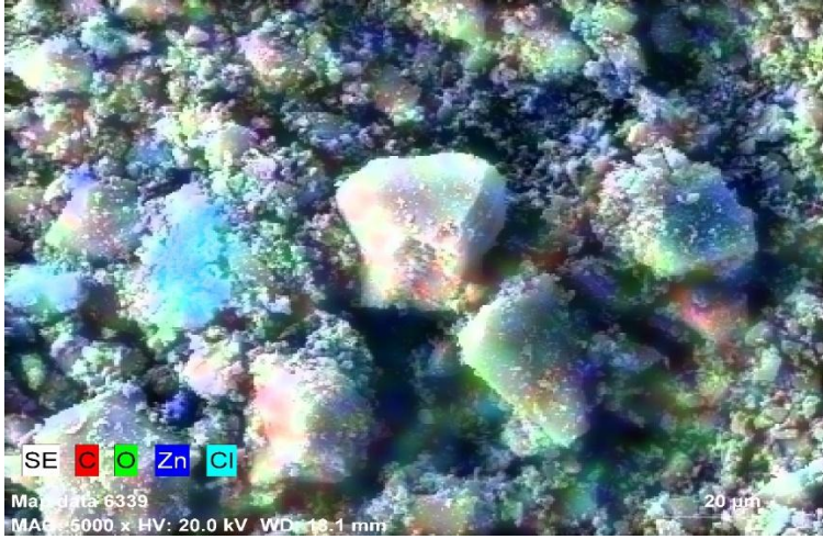
Şekil 17. Element haritalama C (kırmızı), O (yeşil), Zn (mavi), Cl (açık mavi)
