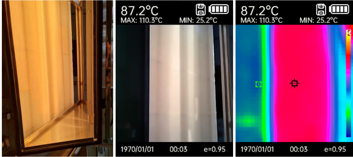
Şekil 4.1. Film yüzeyinde homojen sıcaklık dağılımını gösteren görüntüler; normal kamera görüntüsü, termal kameranın "beyaz mod" ve "gökkuşağı mod" ayarları ile çekilen görüntüler (sırasıyla)
