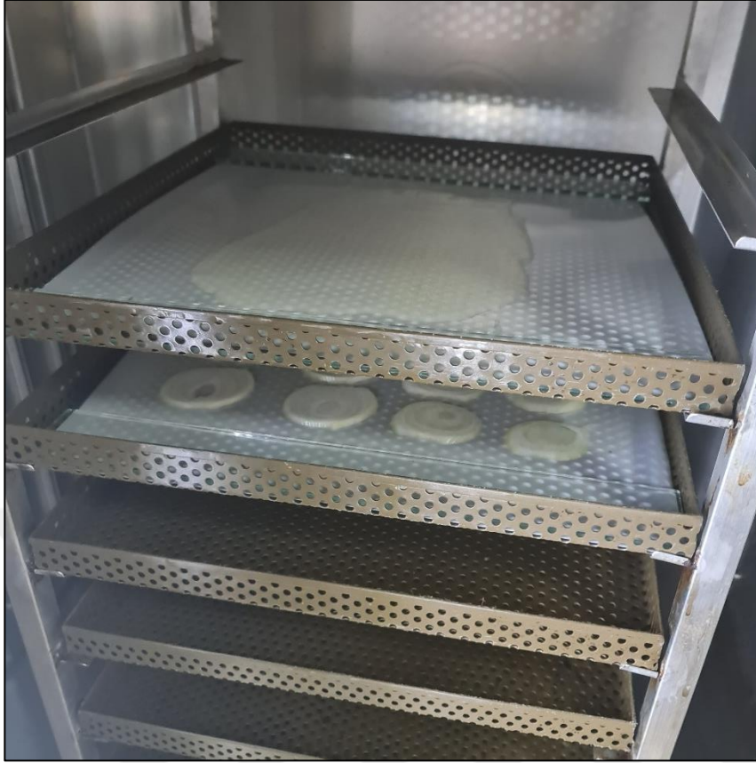
Şekil 3.12. Sıcak havada kurutulan dilim ve püre formda soğan örnekleri
