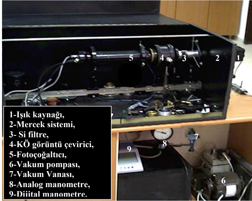
Resim 3.2. KÖ görüntü çevirici deney setinin fotoğrafı. 1. Işık kaynağı (halojen lamba), 2. Mercek sistemi, 3. Si filtre, 4. KÖ görüntü çeviricinin gaz boşalma hücresi, 5. Fotoçoğaltıcı, 6. Vakum pompası, 7. Vakum Vanası, 8. Analog manometre, 9. Dijital manometre.
