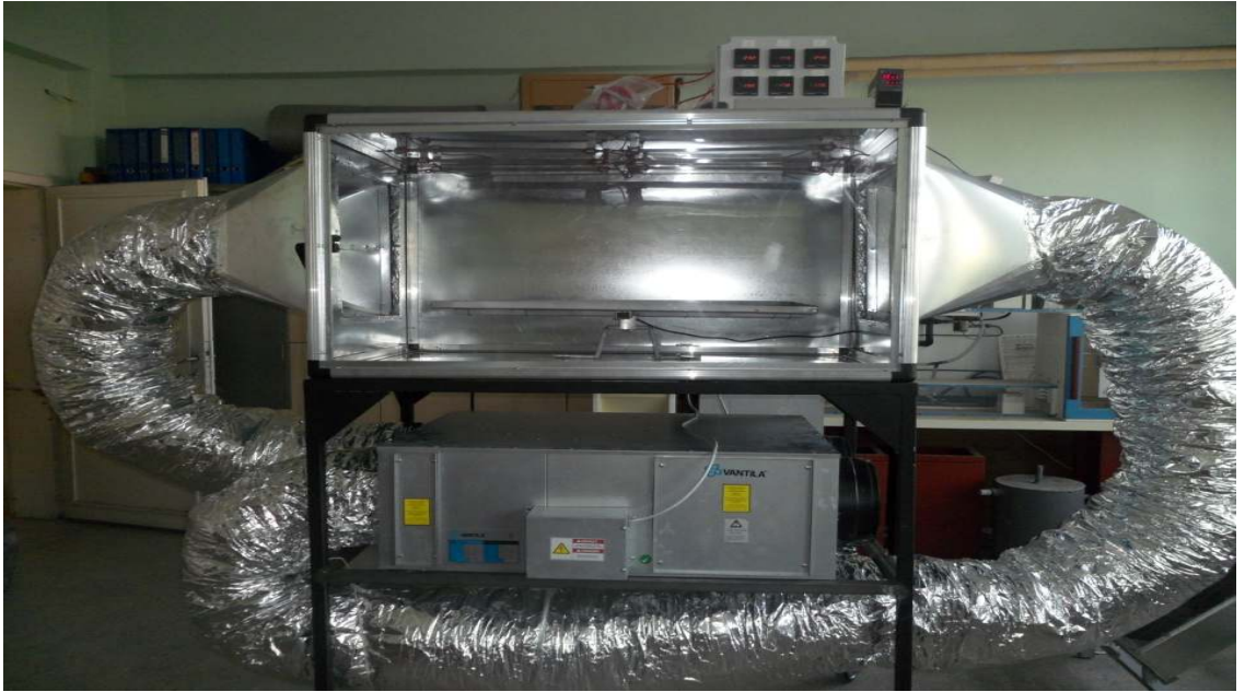
Resim 3.10. Kızılötesi ışınlı (infrared) ısıtıcı kullanan kurutma sistemi ön görünüşü
