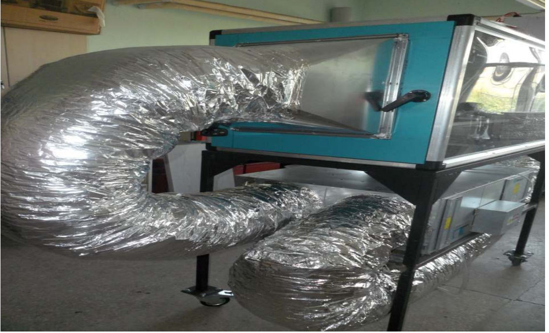
Resim 3.11. Kızılötesi ışınlı ısıtıcı kullanan kurutma sistemi sol yan görünüşü
