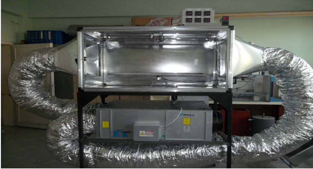
Resim 3.1. Kızılötesi ışıınımlı (infrared) ısıtıcı kullanan kurutma fırını
