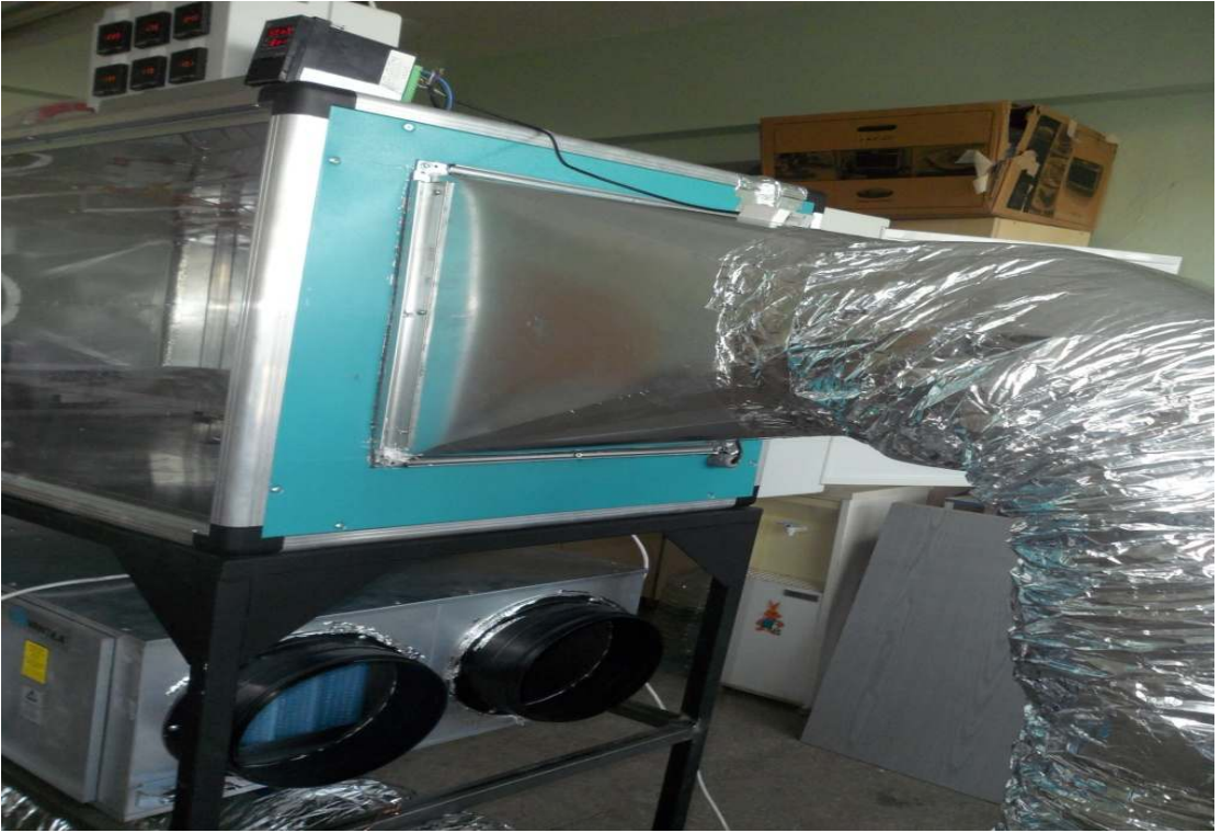
Resim 3.12. Isı geri kazanım cihazı yan görünüşü
