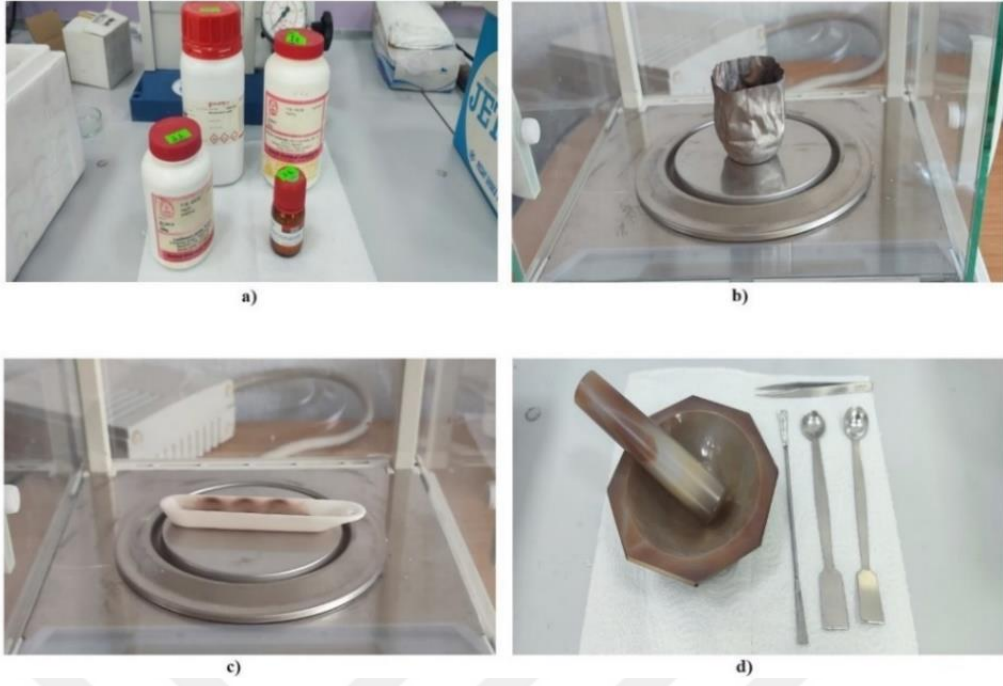
Şekil 5.1: Numune hazırlama aşamaları için gerekli bileşenler. a) başlangıç bileşikleri b) platin kroze c) seramik kroze d) agat havan.
