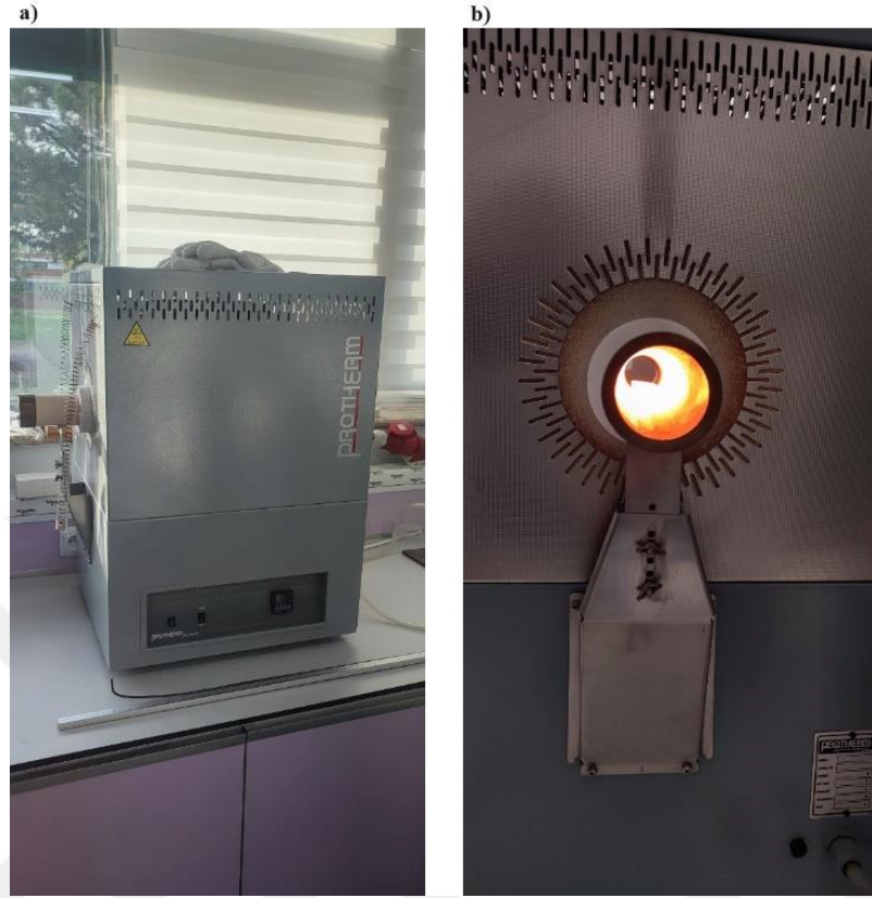
Şekil 5.3: Isıl işlemlerin uygulandığı fırın sistemi a) önden b) yandan görünüm.
