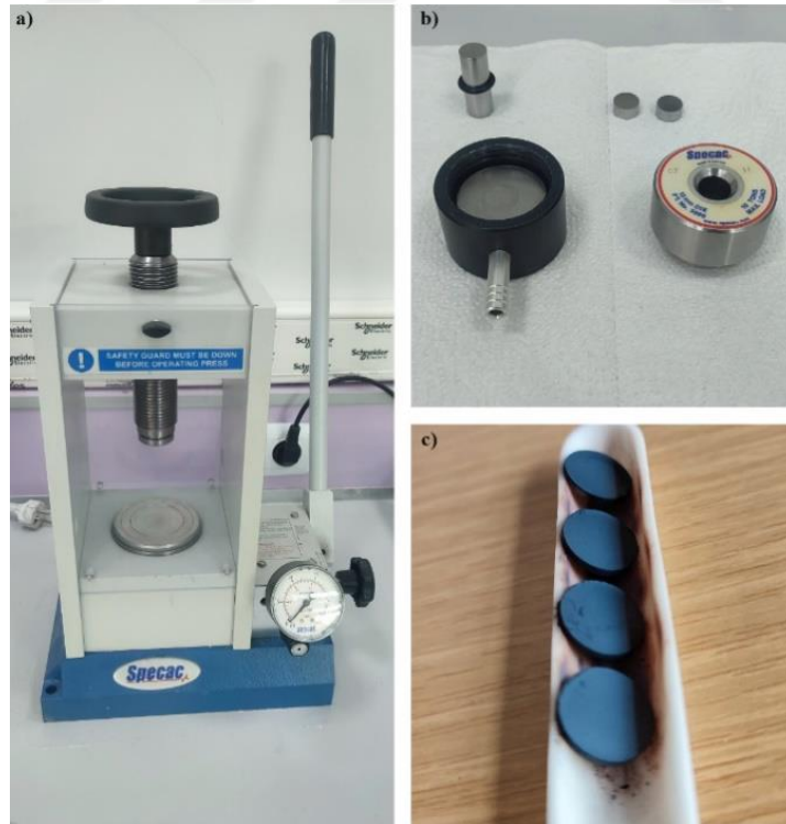
Şekil 5.2: Numunenin pelet haline getirilmesi işlemi a) pres mekanizması b) pres mekanizmasının bileşenleri
