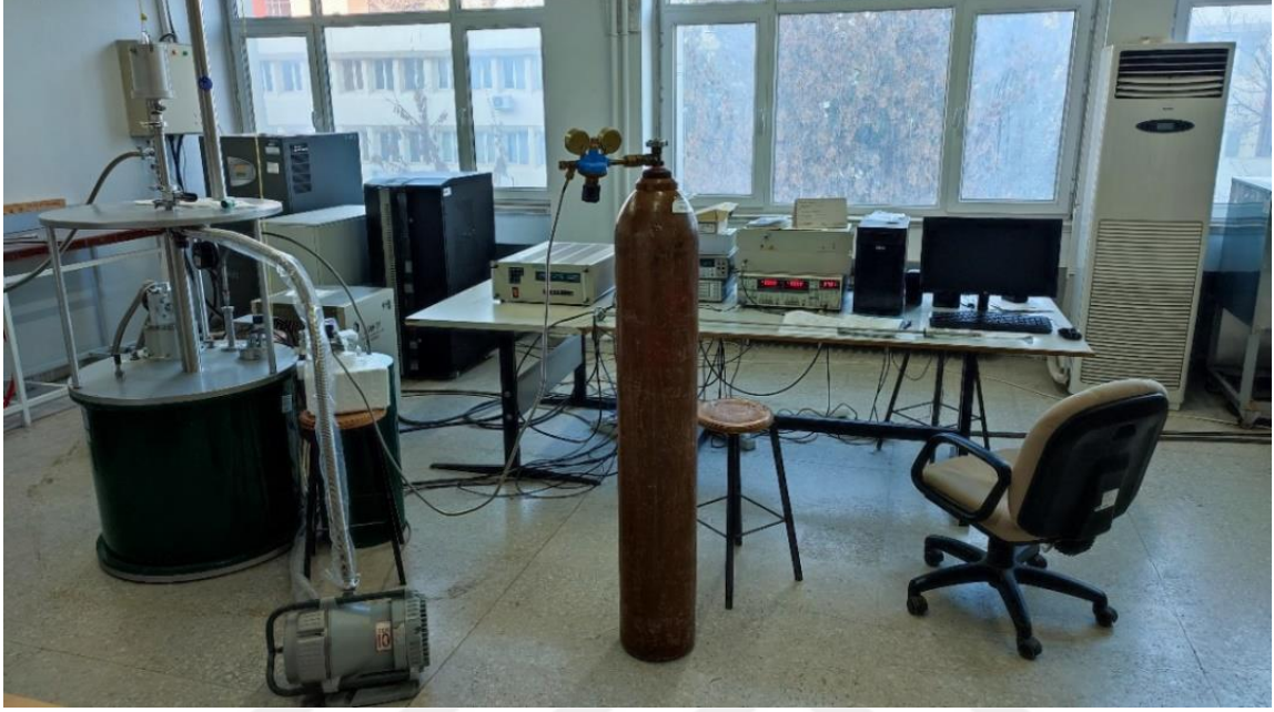
Şekil 5.6: VSM ölçüm sistemi.
