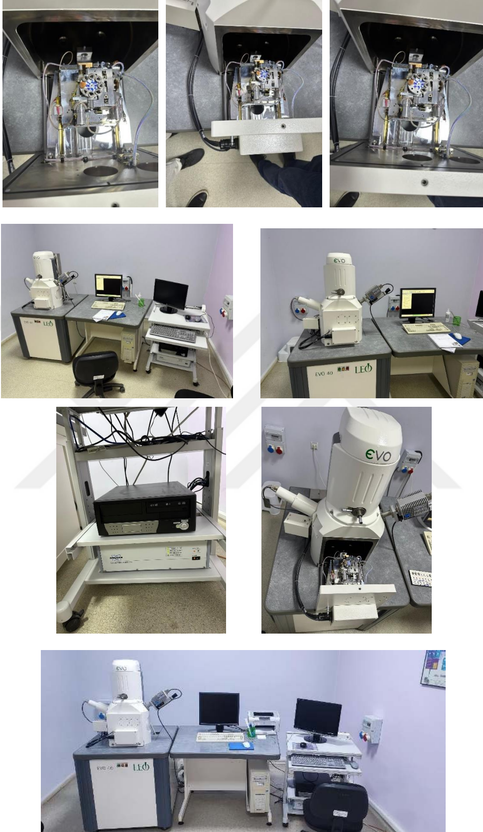
Şekil 5.5: SEM-EDX ölçüm sistemi.
