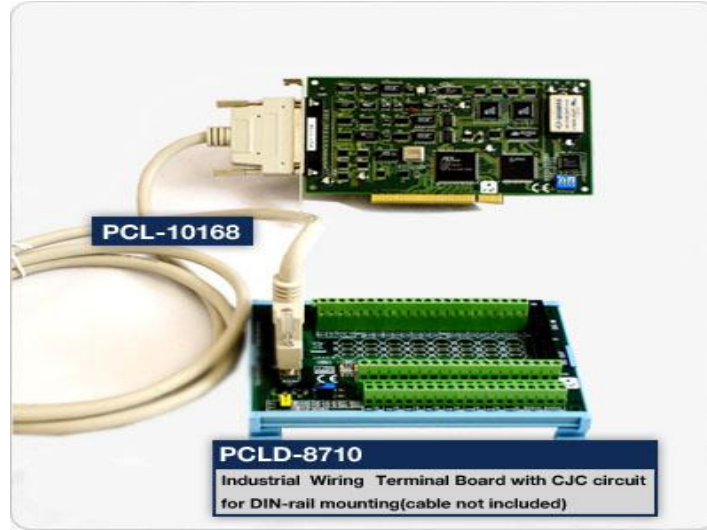
Resim 3.6 PCI-1716 ile PCDL-8710 arası bağlantı
