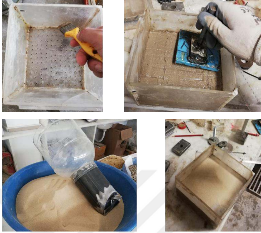
Şekil 5.35. Model Kutusuna zeminin sırasıyla yerleştirilmesi
