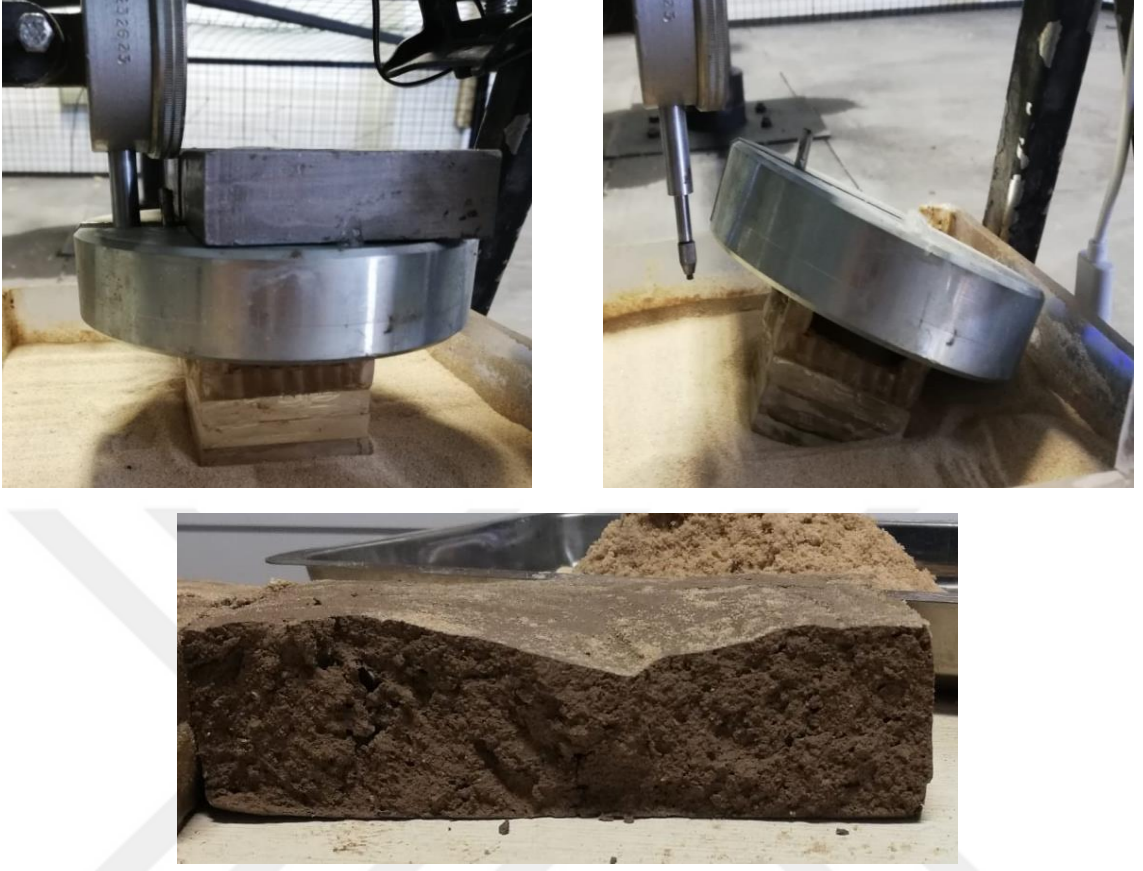
Şekil 5.55. Geoteknik santrifüj modelinde kohezyonsuz zemine oturan eksantrik yüklü rijit temelin oturma davranışı
