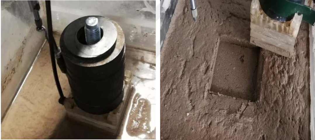
Şekil 5.41. Geoteknik santrifij modelinde kohezyonlu zemine oturan üniform yüklü rijit temelin oturma davranışı
