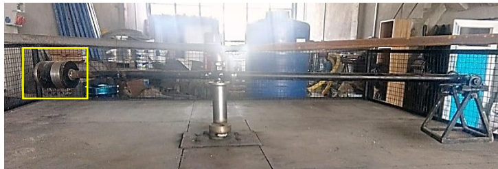
Şekil 5.9. Geoteknik santrifüj dengeleyici ağırlıklar
