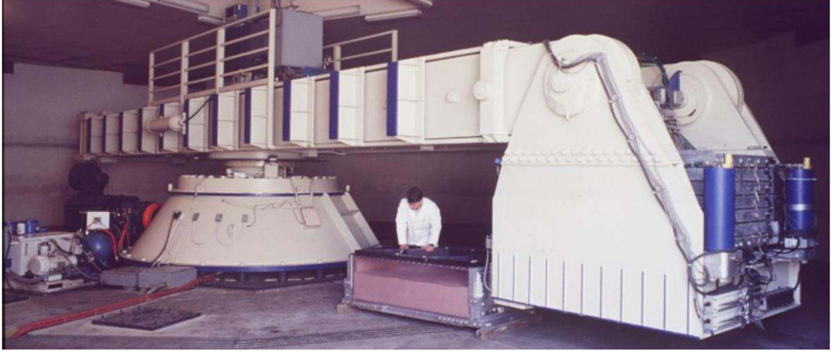
Şekil 3.3. Geoteknik kırıç santrifüjü (University of California )
