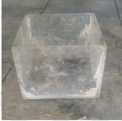
Şekil 5.7. Geoteknik santrifüj model kutusu
