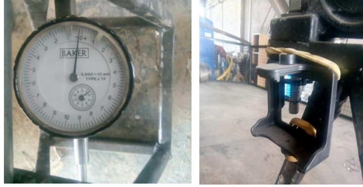
Şekil 5.10. Mekanik komparatör ve kamera haznesi
