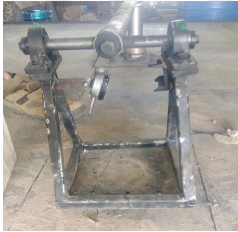
Şekil 5.8. Geoteknik santrifüj platformu
