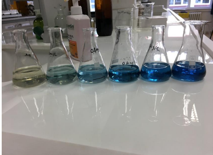
Görsel 3.26. Kalibrasyon Eğrisini Oluşturmak İçin Derişimlere Göre Elde Edilen Renkler
