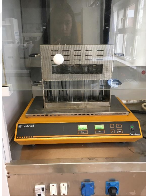
Görsel 3.28. Çeker Ocak İçerisindeki Isıtma Cihazı ile Yakma İşlemi
