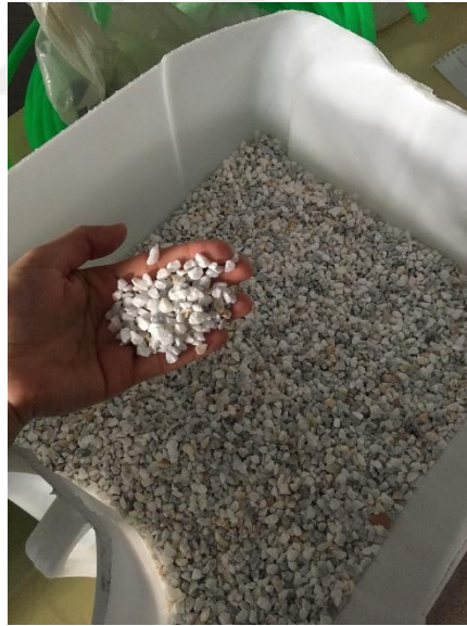
Görsel 3.20. Reaktör ve Dolgu Malzemesi Olarak Kullanılan 5 mm Çapında Çakıl
