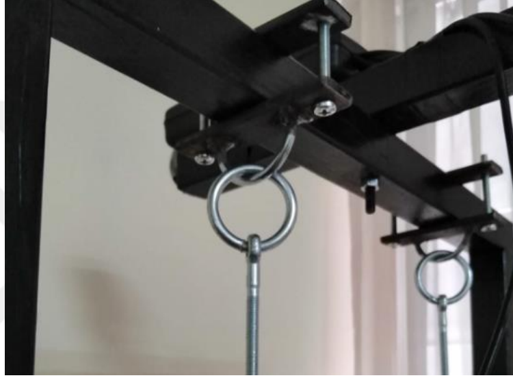
Şekil 3.23. Yük hücrelerin bağlandığı hareketli aparatlar
