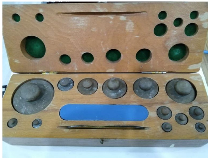
Şekil 3.20. Yük hücrelerinin kalibrasyonu için kullanılan kütleler
