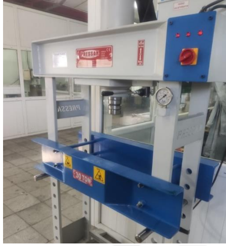
Şekil 3.7. 30 T Hidrolik Pres
