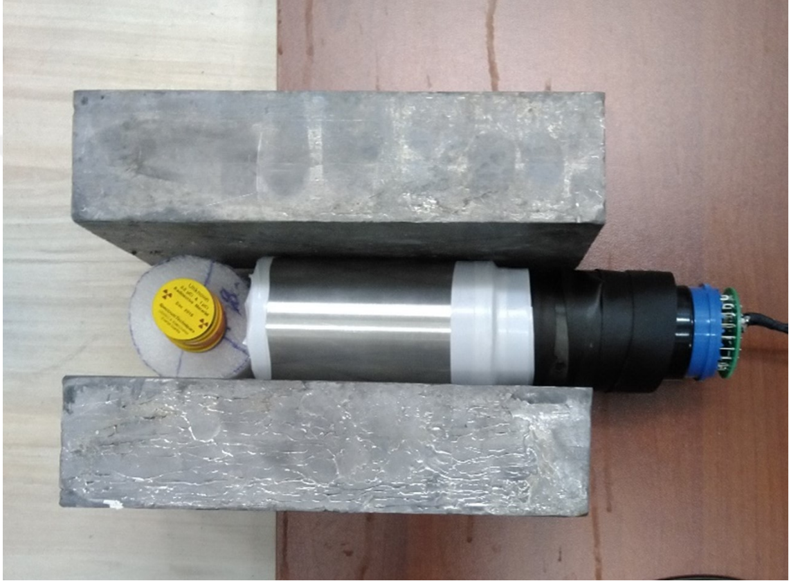
Şekil 4.1. \text{LaBr}_3:\text{Ce} kristalli inorganik sintilasyon dedektörü
