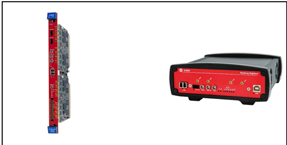
Şekil 3.10. Deneyde kullanılan V1725 (Solda) ve DT5751 (Sağda) sayısallaştırıcılar
