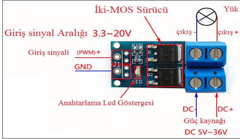
Şekil 3.29. MOSFET sürücü kartı
