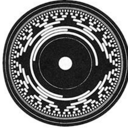
Şekil 2.17. Mutlak enkoderde kullanılan disk (Beach ve McMillan, 1999)
