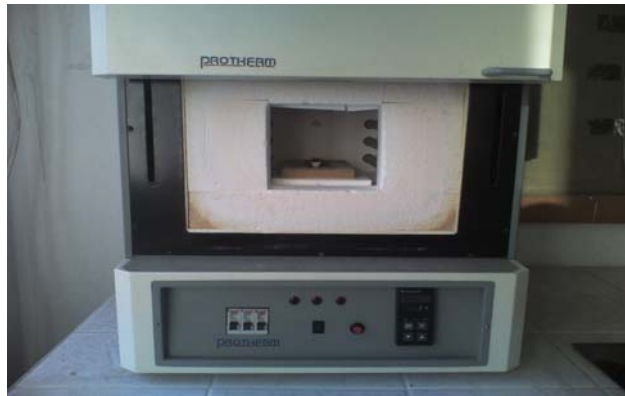
Şekil 4.10 Pelet halinde nanoparçacıkların ısıtılma işlemi için kullanılan kül fırın [47]
