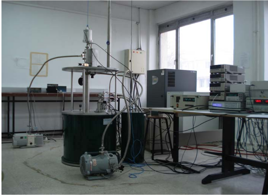
Şekil 4.6 Vibrating Sample Magnetometer (VSM) sisteminin fotoğrafı[47].
