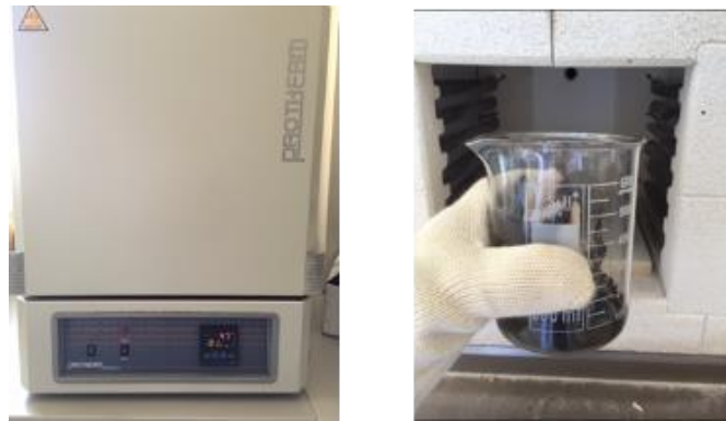
Şekil 3.2 Kül fırın ve yakma işlemi
