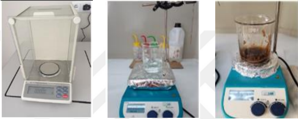
Şekil 3.1 Başlangıç bileşiklerinin hassas terazi ile tartılması ve tüm çözeltilerin birleştirilip manyetik karıştırıcıda sol-jel yöntemi ile jel kıvamı elde edilmesi.
