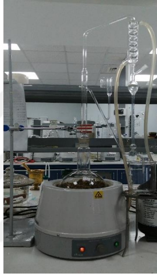
Şekil 3.3. Bitkisel materyalin (meyve) Clevenger apareyinde hidrodistilasyonu
