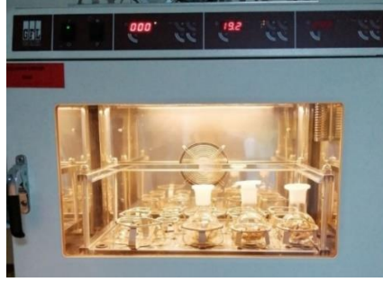
Şekil 3.8. Bitkisel materyallerin (meyve, yaprak, kök) %60'lık metanol ile çalkalayıcıda maserasyonu
