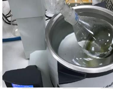
Şekil 3.9. Ekstrelerden rotavapor ile çözücü uzaklaştırma işlemi
