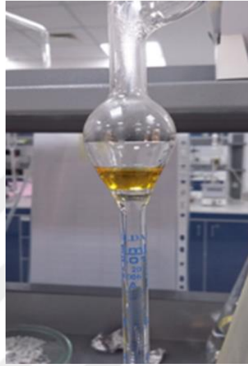
Şekil 4.1. L. cuminoides bitkisinden Clevenger apareyinde uçucu yağın elde edilmesi
