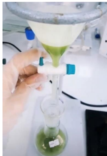
Şekil 3.6. Ekstre saflaştırma çalışması: %0,4'lük \text{CaCl}_2 çözeltisi ile yıkama işlemi
