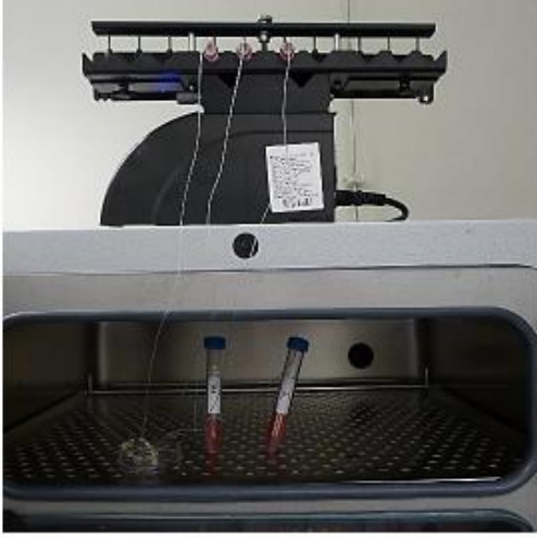
Şekil 22. Şırınga pompasının inkübasyon makinesi üzerindeki yerleşimi ve lakrimal çipin inkübasyon makinesi içerisindeki görünümü
