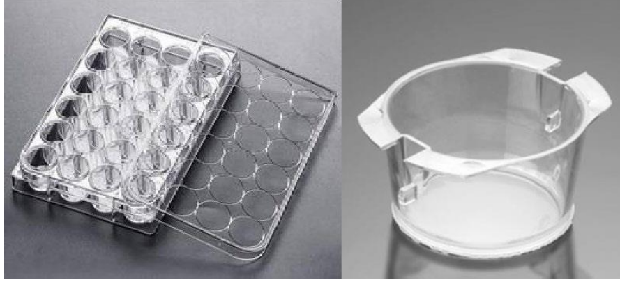
Şekil 3. 4. Kokültür modeli için kullanılan 24 kuyucuklu plaka (Sol) ve 0.4 µm por açıklığına sahip üst odacık
