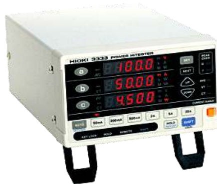
Şekil 4.7 Kesme deneylerinde kullanılan enerji analizörü (Eken 2013).
