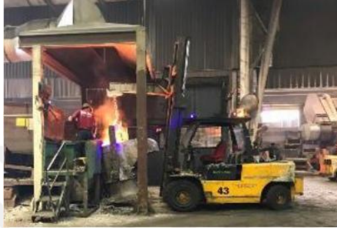
Şekil 4.8. Cüruf temizleme istasyonu
