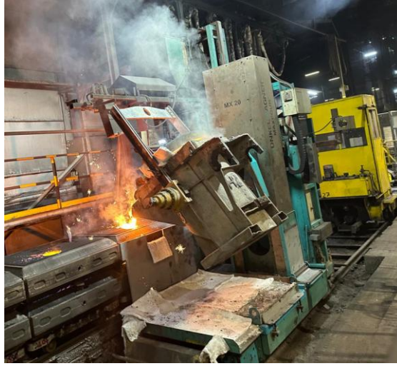
Şekil 4.10. Pota döküm arabasına yerleştirilmiş döküm anı görseli
