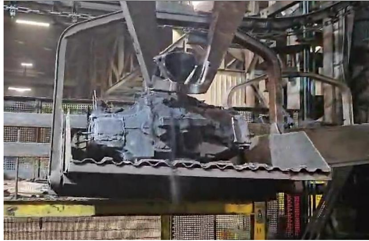
Şekil 4.11. Kalıp bozma bölgesinden konveyöre andromat yardımıyla parça yükleme
