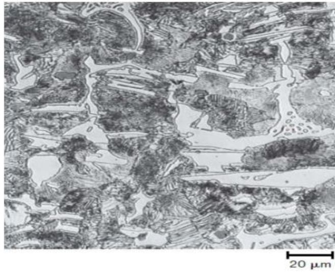
Şekil 3.6. Beyaz dökme demire ait mikroyapı fotoğrafı. Açık renkli bölgeler sementit, koyu renkli bölgeler ise perlit [3]
