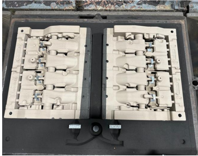
Şekil 4.4. Maça ve Filtreler yerleştirildikten sonraki görüntüsü
