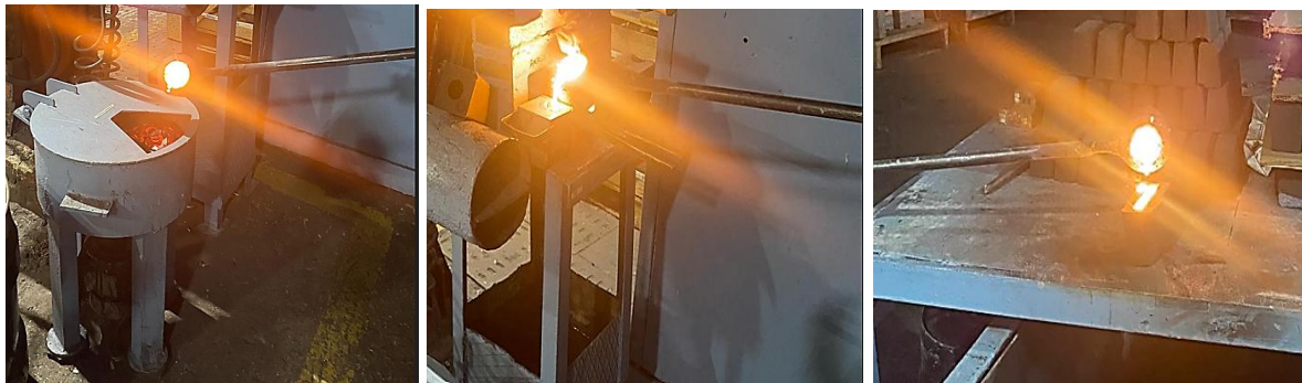
Şekil 4.9. Spektro numune alma – karbon-kükürt numune alma – çil ölçümü numune alma
