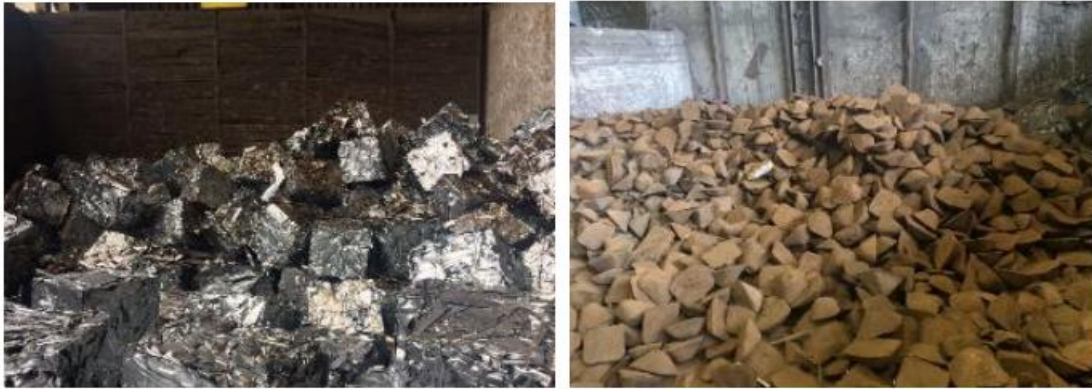
Şekil 4.6. Şarj malzemesi olarak kullanılan DKP sac (solda) ve gri piki (sağda)
