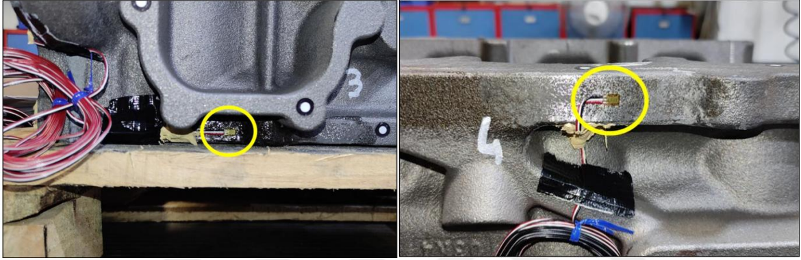
Şekil 5.9. Gerinim ölçerlerin 3.ve 4. Noktalarında yerleştirilme görüntüsü
