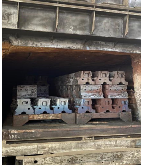
Şekil 4.14. Palet üzerine alınmış motorların tav fırınına yüklenmiş görseli
