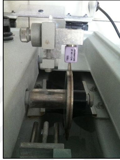
Resim 29: Blokların dilimlenebilmesi için kullanılan kesme cihazı
