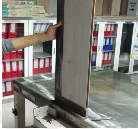
Şekil 3.6: Gönyeden Sapma Kontrolü
